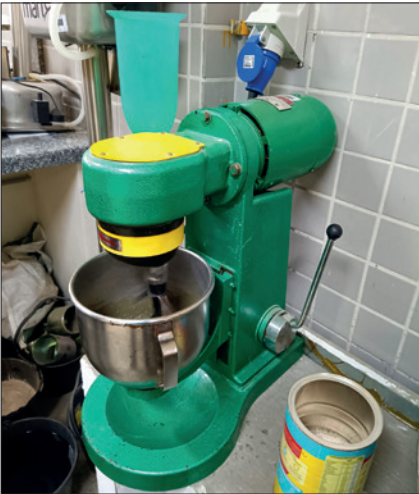
FIGURA 2 ARGAMASSADEIRA E MESA DE CONSISTÊNCIA UTILIZADA NA PESQUISA FONTE: AUTORES
