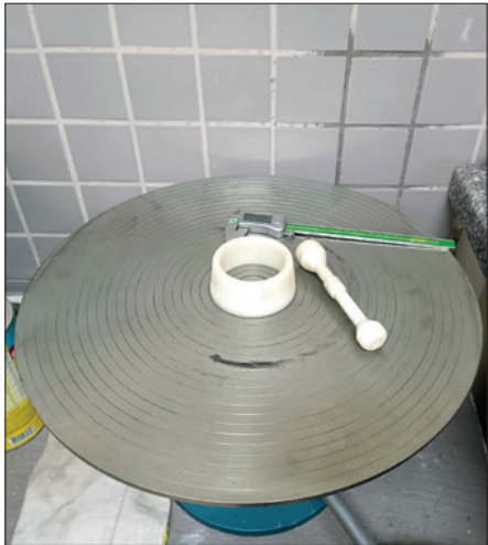
FIGURA 2 ARGAMASSADEIRA E MESA DE CONSISTÊNCIA UTILIZADA NA PESQUISA FONTE: AUTORES
