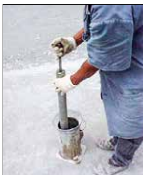
FIGURA 6 PROCEDIMENTOS DE MOLDAGEM DOS CORPOS DE PROVA
