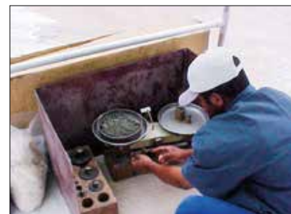
FIGURA 5 PROCEDIMENTOS PARA DETERMINAÇÃO DO TEOR DE UMIDADE
