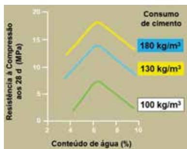
FIGURA 2 RELAÇÃO ENTRE QUANTIDADE DE ÁGUA E RESISTÊNCIA À COMPRESSÃO PARA TRÊS FAIXAS DE CONSUMO DE CIMENTO
