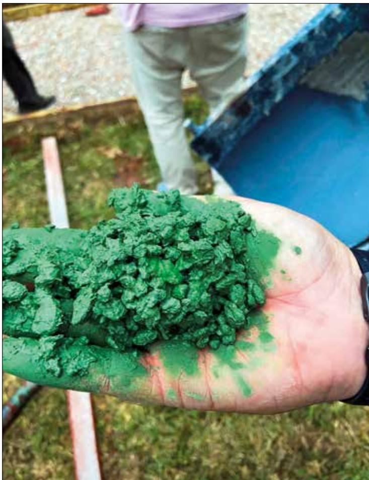
Foto 2 — Consistência do pavimento permeável colorido
