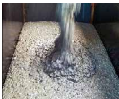
FIGURA 5 ASPECTO DO CONCRETO AUTOADENSÁVEL SF 1
