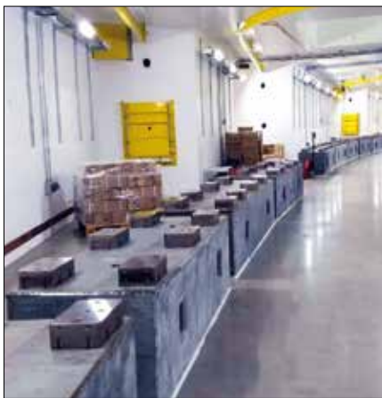
FIGURA 19 BASES INSTALADAS NO LABORATÓRIO SIRIUS PARA MONTAGEM DO CONJUNTO DE ELETROÍMÃS FONTE: PRÓPRIO AUTOR (2017)
