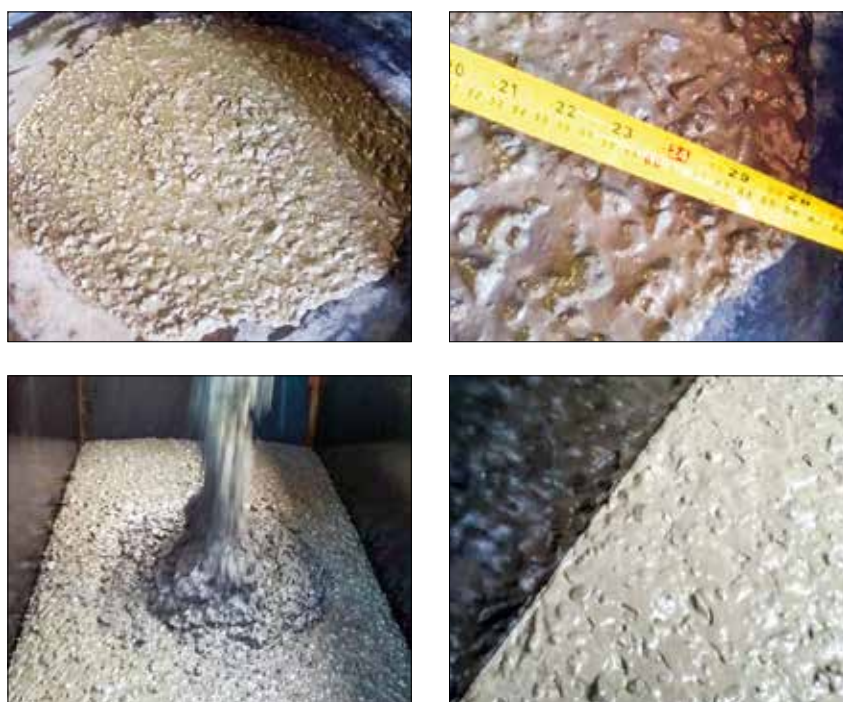
FIGURA 5 ASPECTO DO CONCRETO AUTOADENSÁVEL SF 1
