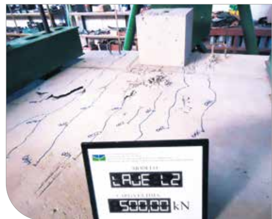
Mapeamento de fissuras e carga última
