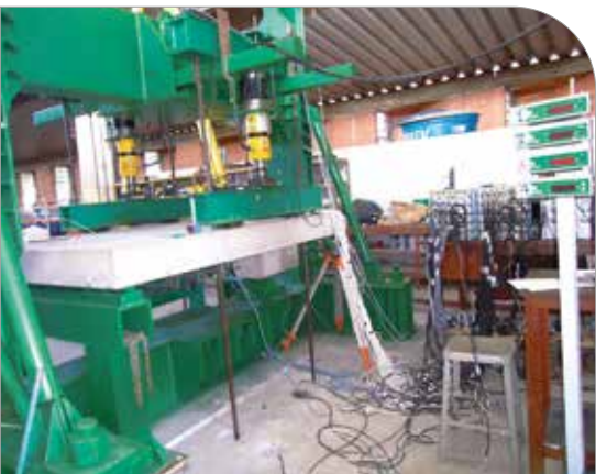
Laje posicionada para ensaio de punção
