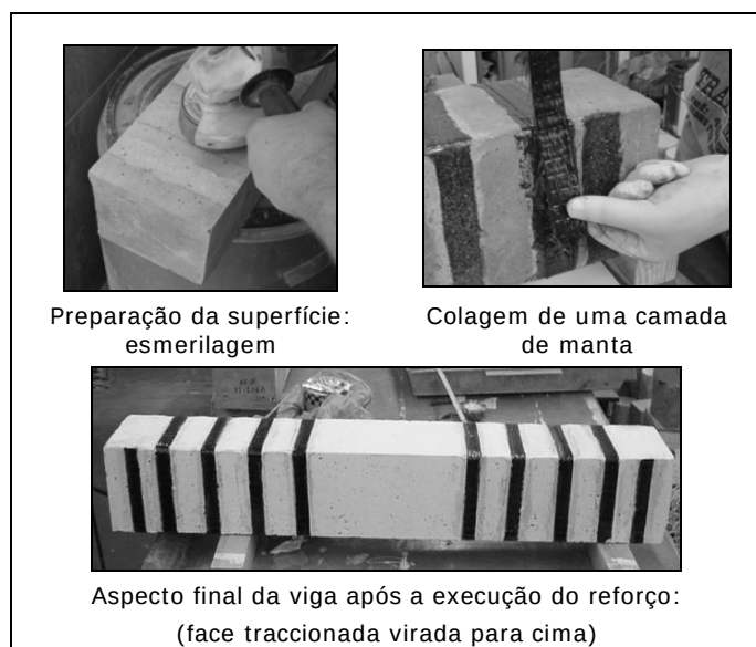
Figura 3 - Reforço ao corte por intermédio da colagem de externa de mantas de CFRP.
