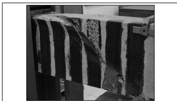
**Figura 4 - Detalhes do modo de ruptura das vigas V9\_A, V9\_B e V21\_A.**
