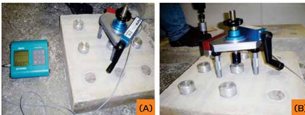
Figura 6 – Método "Pull Off" com e sem corte (Adaptado de MALHOTRA e CARINO, 1991)
