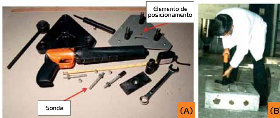
Após a projeção das sondas, retira-se o elemento de posicionamento da sonda e escovam-se os pedaços que se desagregaram do concreto. Antes de se proceder às medições, é necessário verificar se todas as sondas estão firmemente cravadas no concreto (bater levemente com um martelo). A variável de leitura é o comprimento do pino que fica exposto, que tem relação direta com a resistência mecânica do concreto (MEHTA e MONTEIRO, 2008).
