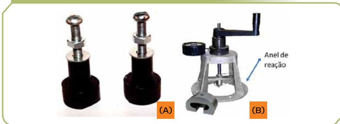
nesse caso, o ensaio não precisa ser levado até o fim, sendo suficiente a aplicação de uma carga pré-estabelecida. Se a peça não for arrancada, pode-se admitir que o concreto atingiu a resistência correspondente. Malhotra e Carino (1991) defendem que este ensaio é preferível ao esclerométrico, pois envolve maior volume de concreto.
