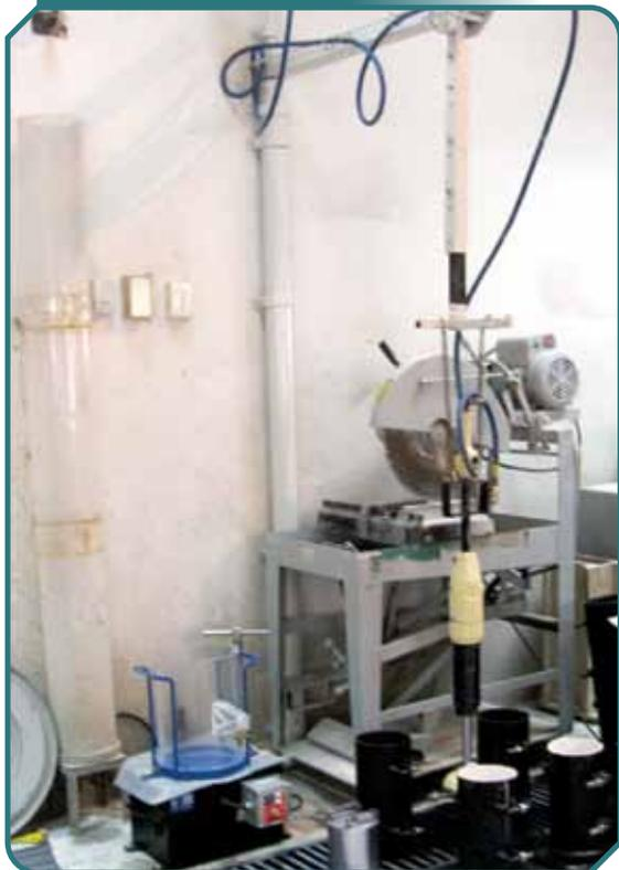
Figura 7 – Colocação do concreto no DMA utilizando o volume do cilindro de VeBê (Laboratório da Holcim, na Cidade do México, 2007)
