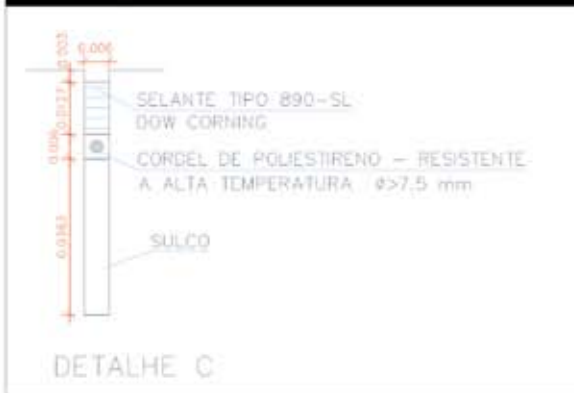
6 - Selagem das Juntas
