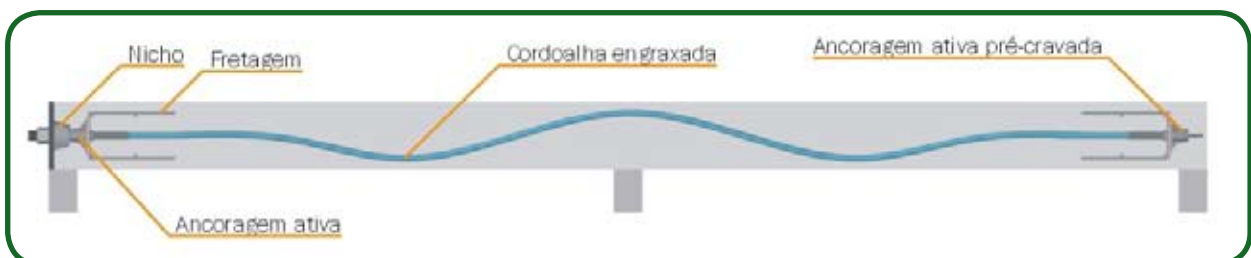
Fig. 3 – Representação esquemática de um cabo de monocordoalha engraxada em corte longitudinal
