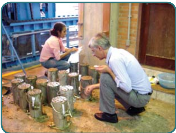
Figura 9 – Fôrmas totalmente preenchidas
