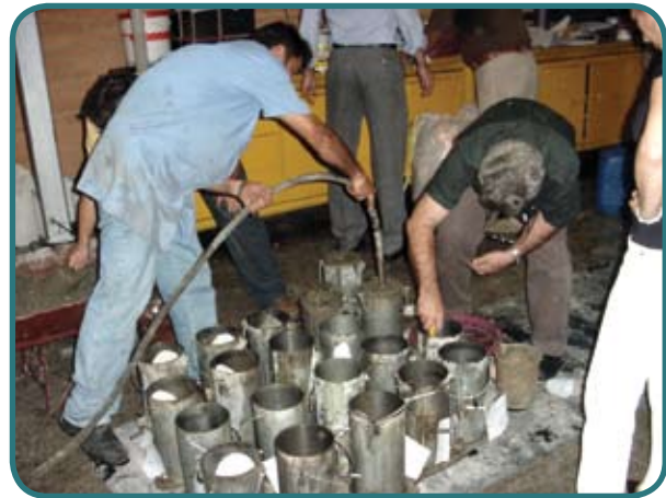
Figura 8 – Concreto novo sendo vibrado
