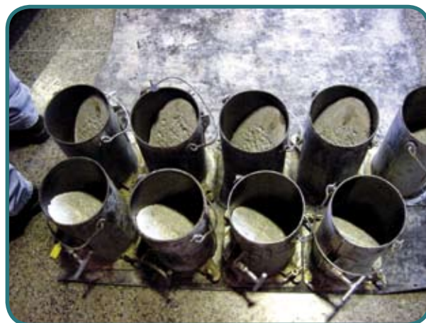
Figura 4 – Fôrma com concreto apicoado
