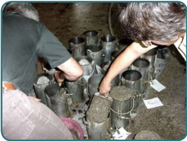
Figura 7 – Aplicação do concreto novo
