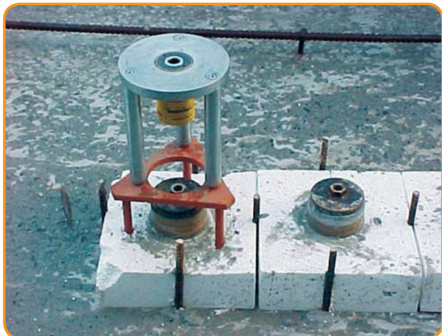
Foto 3 – Ensaio de arrancamento para teste de aderência
