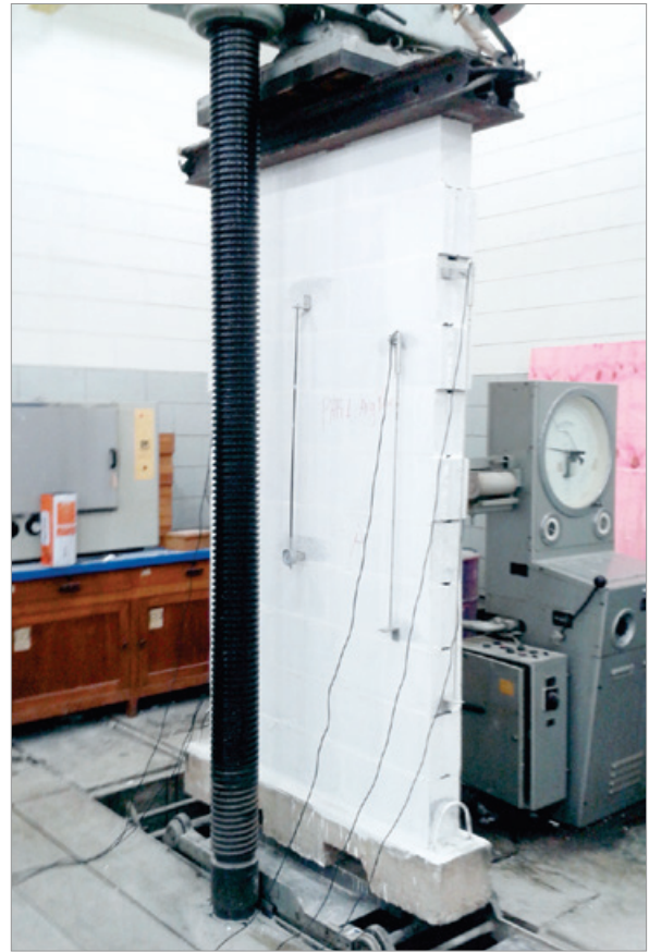
Figura 5 – Ensaios de prismas e paredes com blocos de concreto de alta resistência realizados na CESP – Ilha Solteira, dentro do doutorado de Ernesto Silva Fortes - UFSCar sobre “Comportamento de Edifícios Altos em Alvenaria Estrutural” - Projeto FAPESP 12/22454-0
