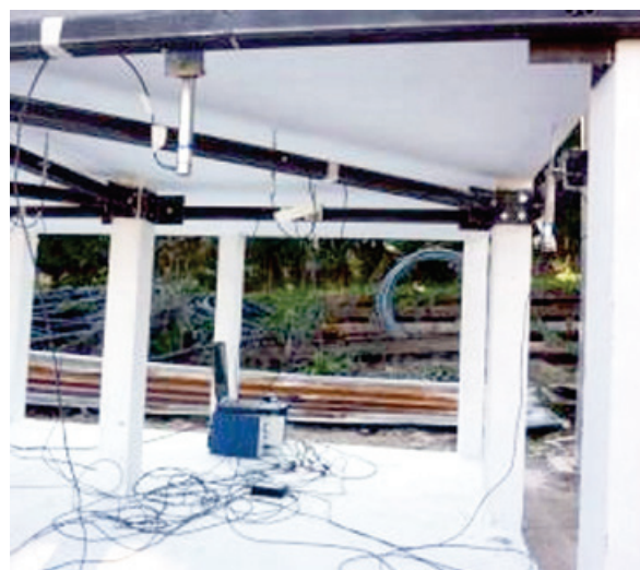
Figura 7 – Estrutura de suporte dos transdutores de deslocamentos
