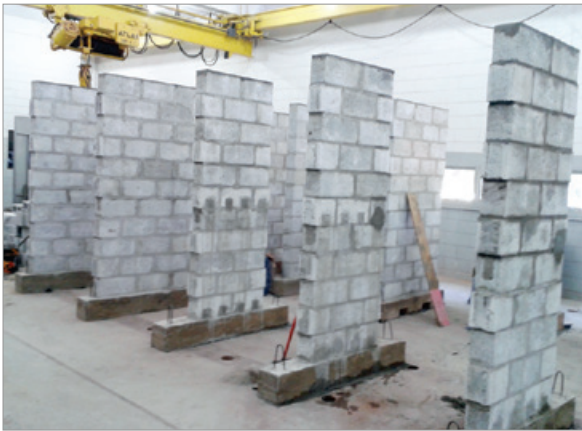
Figura 5 – Ensaios de prismas e paredes com blocos de concreto de alta resistência realizados na CESP – Ilha Solteira, dentro do doutorado de Ernesto Silva Fortes - UFSCar sobre “Comportamento de Edifícios Altos em Alvenaria Estrutural” - Projeto FAPESP 12/22454-0
