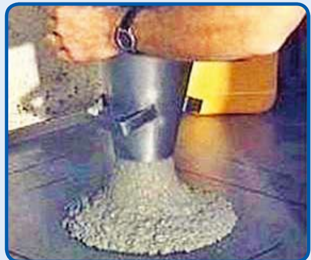
Slump test do Concreto Auto-Adensável (CAA)
