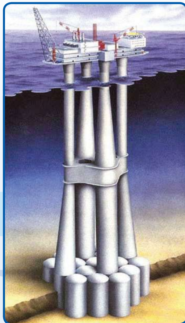
Desenho esquemático da Troll Platform, estrutura de concreto com 472m de altura, a mais alta do mundo para uma estrutura móvel
