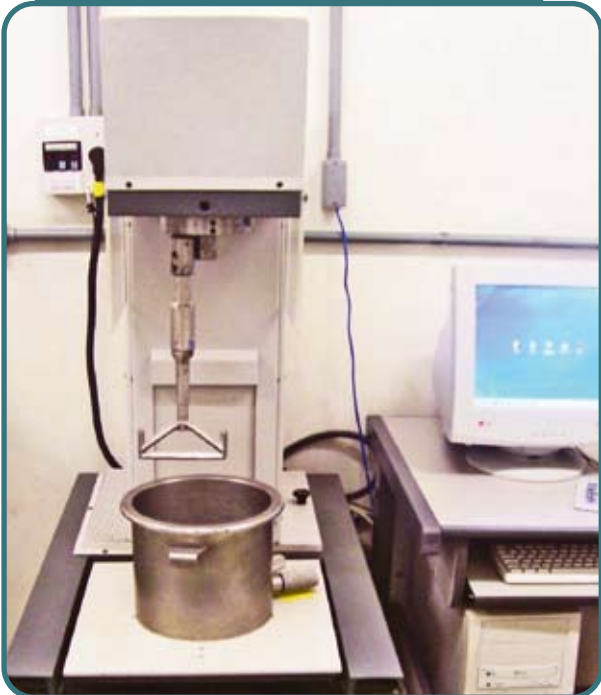
Figura 2 – Reômetro planetário da “2ª geração”
