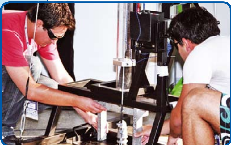
Estudante posiciona o APO para ser submetido a carga dinâmica
