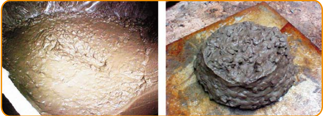
Figura 1 – Concreto com teor de argamassa de 57%
