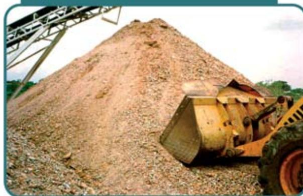
Figura 2 – Trituração de resíduos cerâmicos, de modo a reduzir a sua granulometria
