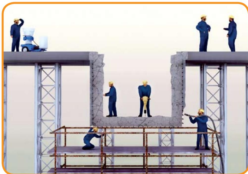
Figura 2 – Esquemático mostrando trabalhos internos e externos nos canais - demolição do concreto existente e reconstituição e reforço com concreto projetado
