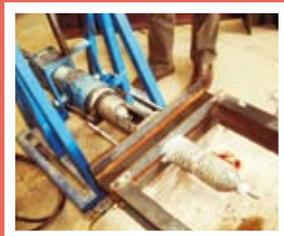
Ensaio de aderência aço-concreto para controle de qualidade
