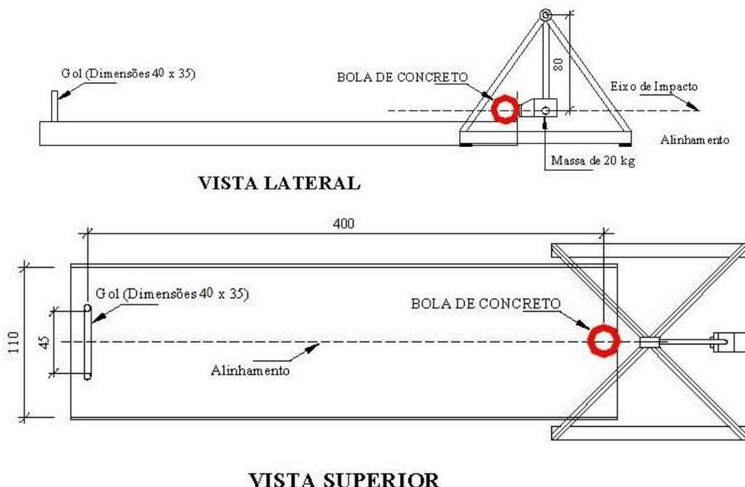
**FIGURA 1 – Equipamento de impulso, Pista de rolamento e Gol**
