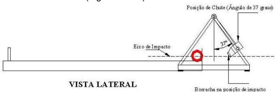
**FIGURA 2** – Equipamento na posição de impulsionar a BOLA
