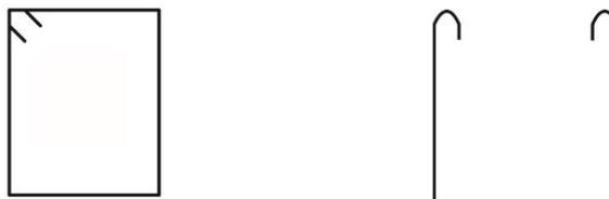
Figura 1 – Configurações de estribos permitidas
