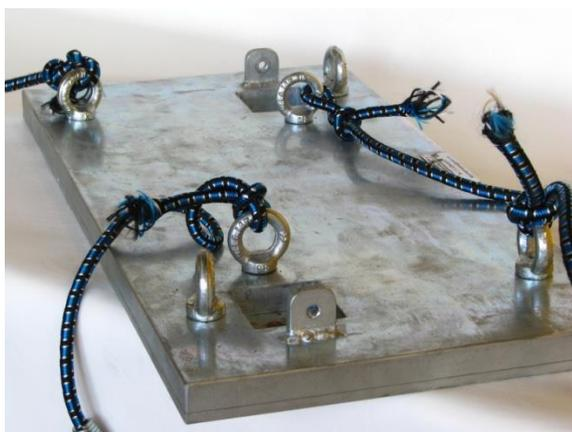
**Figura 3 – Foto do Gabarito com cordas de fixação**
