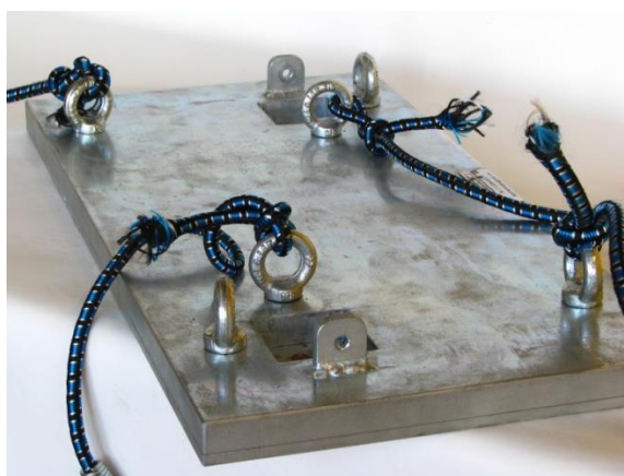
Figura 3 – Foto do Gabarito com cordas de fixação
