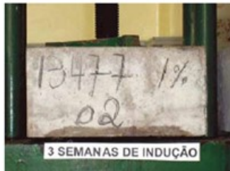
Probeta con 1% de adición de Penetron Admix; tres semanas de inducción
