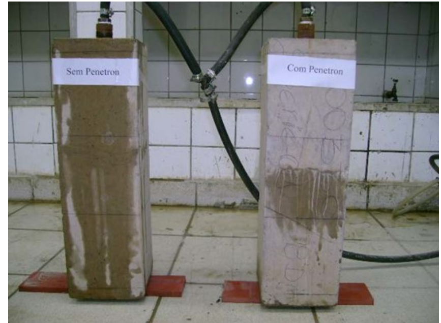
Probeta con 1% de adición de Penetron Admix; dos semanas de inducción
