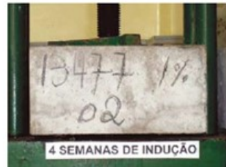
Probeta con 1% de adición de Penetron Admix; cuatro semanas de inducción
