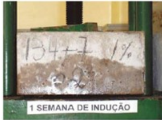
Probeta con 1% de adición de Penetron Admix; una semana de inducción
