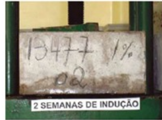
Probeta con 1% de adición de Penetron Admix; dos semanas de inducción
