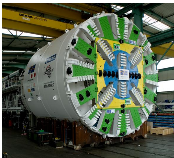
Figura 5- EPB TBM via dupla usado recentemente pelo Metrô de São Paulo na Linha 4 Amarela ( Metrô-SP)
