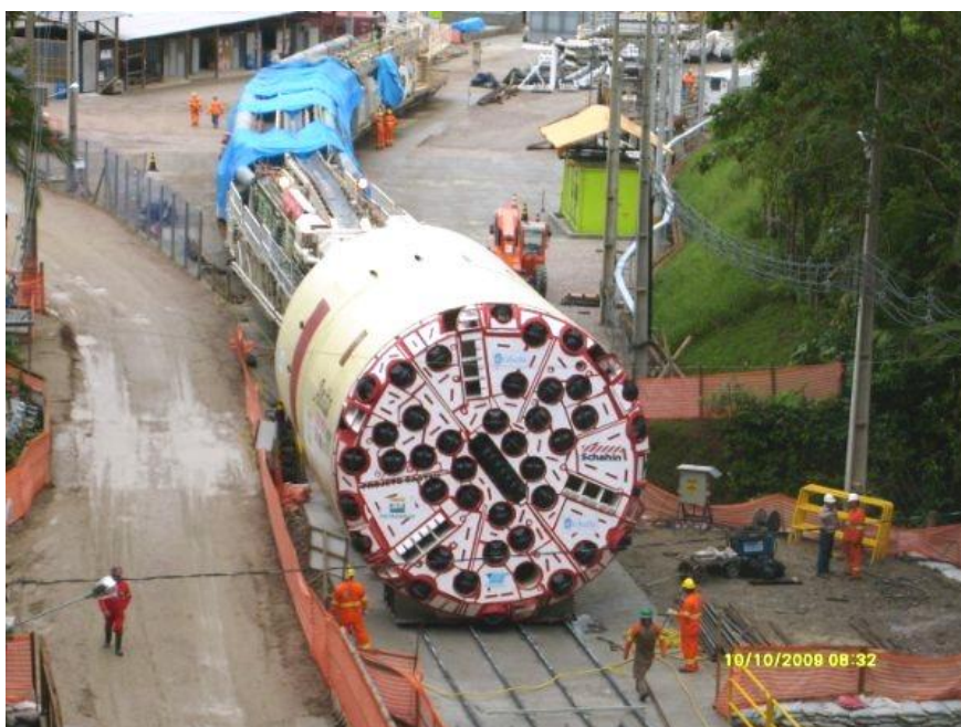
Figura 6- TBM Double Shield Hard Rock, usado recentemente pela Petrobrás (ELSNER 2009)
