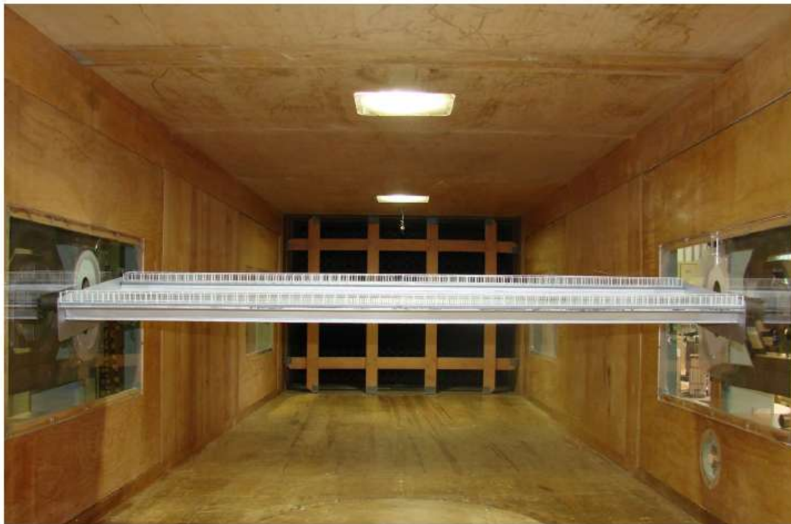
Modelo seccional do tabuleiro da Nova Seção da Ponte Estaiada sobre o Rio Negro no interior do Túnel de Vento – Configuração II - COM GUARDA-CORPO.
