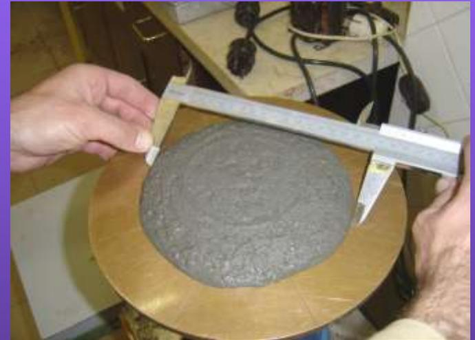
Ensaio de consistência por espalhamento- Norma EN 1015-3.
