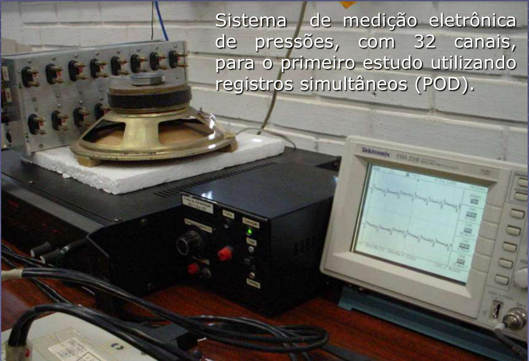
Sistema de medição eletrônica de pressões, com 32 canais, para o primeiro estudo utilizando registros simultâneos (POD).
