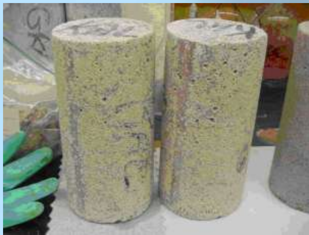
Probetas con KF-A a los 16 ciclos.
