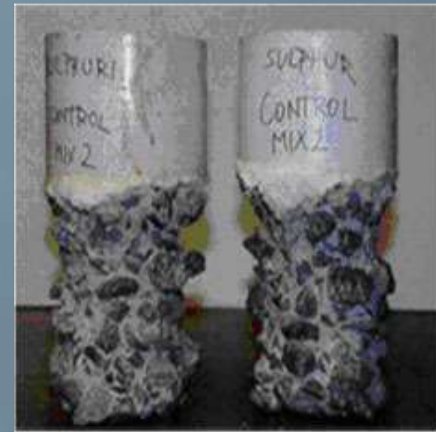
Muestra de control, expuesta a una disolución de ácido al 10%.
