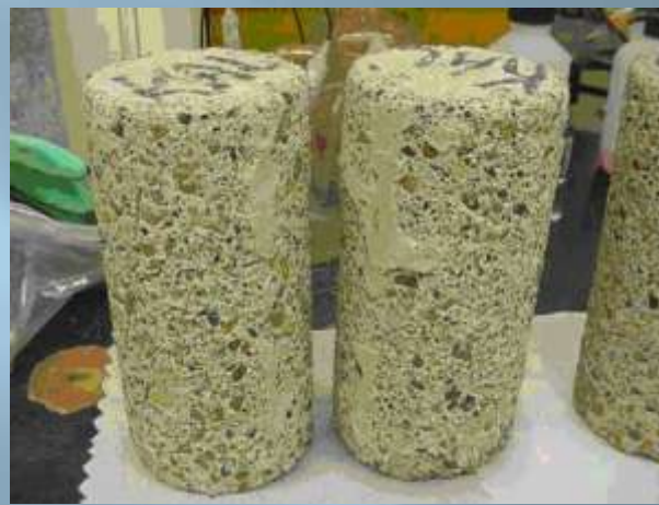
Probetas con KF-A a los 50 ciclos.
