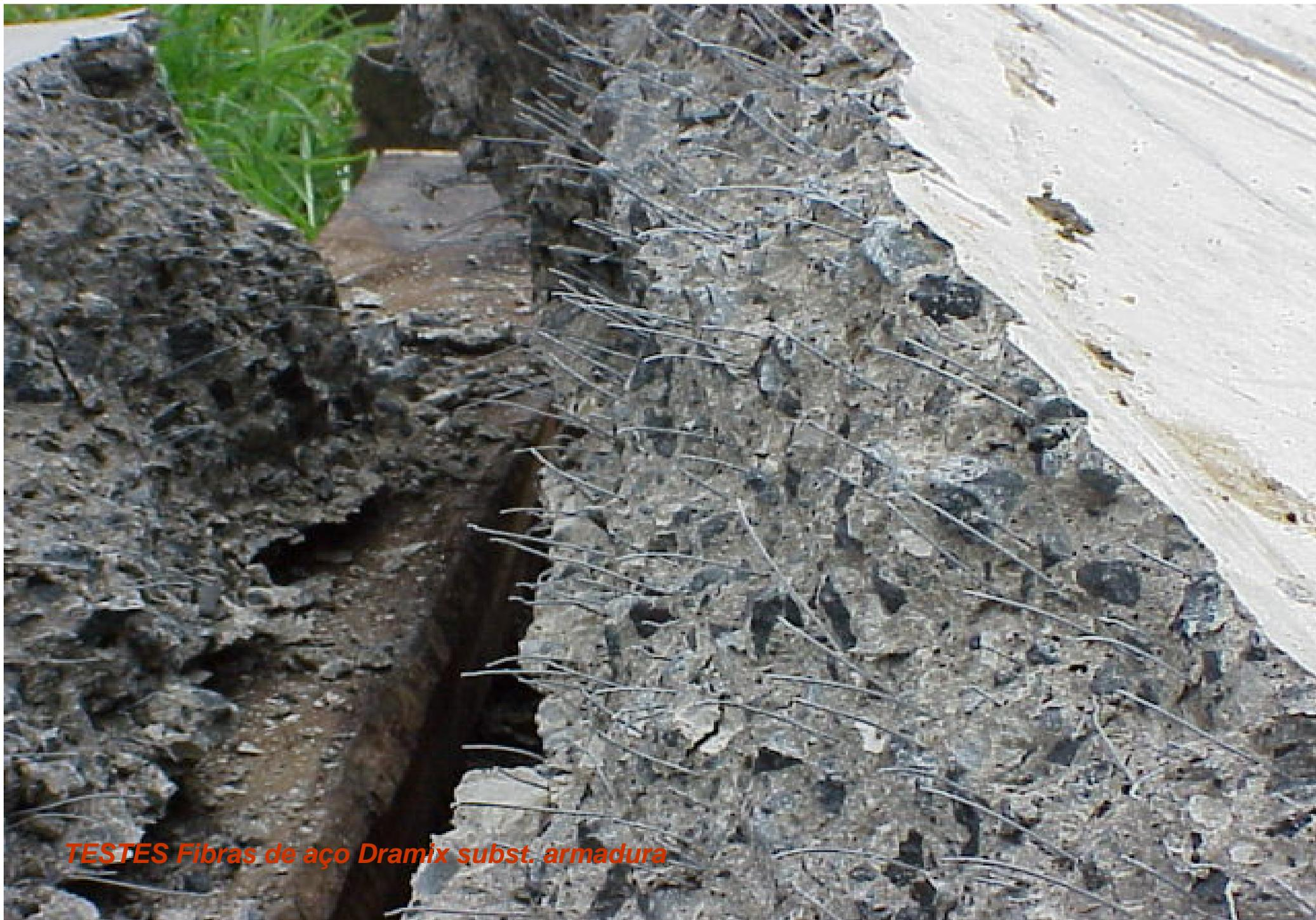
*TESTES Fibras de aço Dramix subst. armadura*
