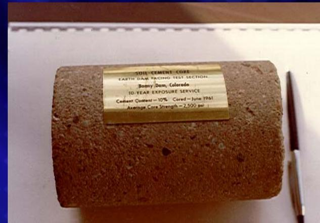
Testemunhos extraídos em 1961, do Solo Cimento (consumo de 10% de Cimento Comum) utilizado na **Barragem de Bonny- Colorado**, indicando uma resistência de 17,6MPa, vários anos após a construção
