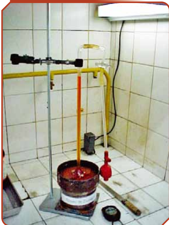
Figura 3 – Ensaio de velocidade de exsudação. Pode-se verificar a bureta com tetracloreto de carbono ( Cl_4C ) com líquido indicador, possibilitando a leitura do volume de água ascendente (ASTM C 243, 2008)
