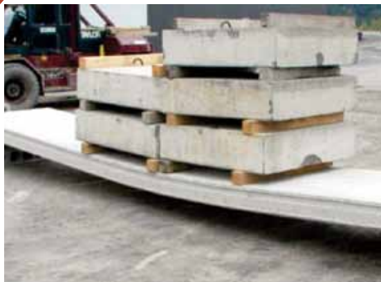
Figura I – Prova de carga realizada em fábrica (esq.). Ensaio de flexão realizado em laboratório (dir.).
