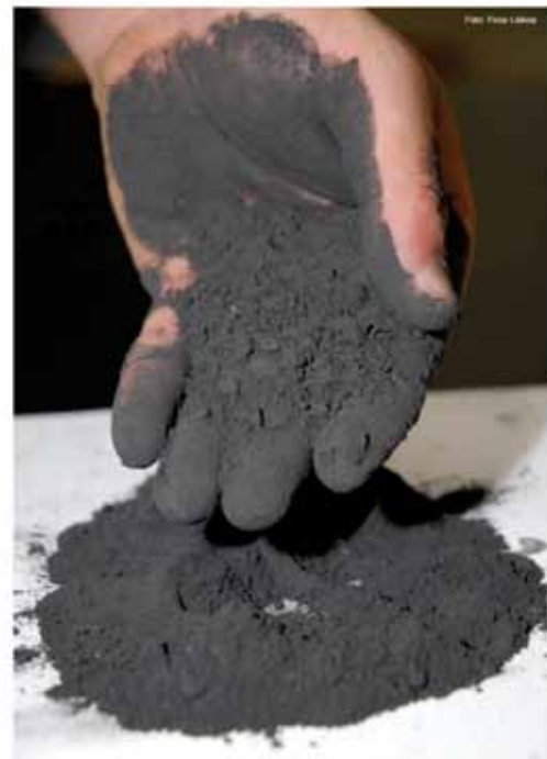
Figura 10 – Cimento produzido com nanotubos de carbono já incorporados, confeccionados na UFMG ( www.ufmg.br/boletim_bol1622/index.shtml )
