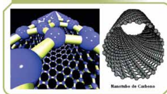
Figura 2 – Estruturas de nanotubos de carbono (à esquerda por B. Piropo e à direita pela OZONIC)
