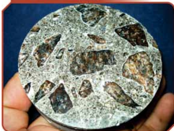
Figura 13 - Face polida de um corpo de prova extraído
