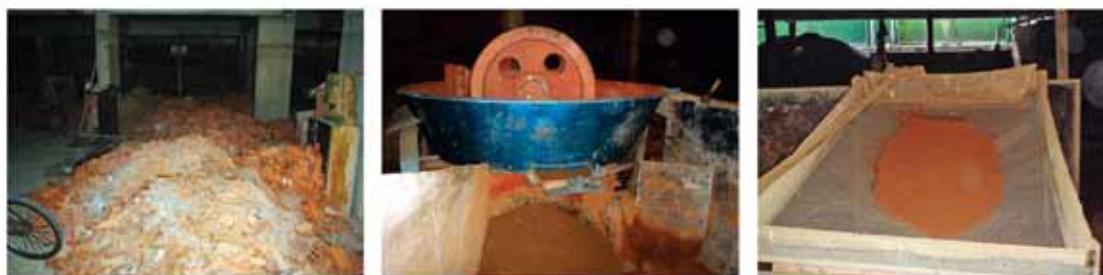
Figura 3 – Produção do agregado reciclado
