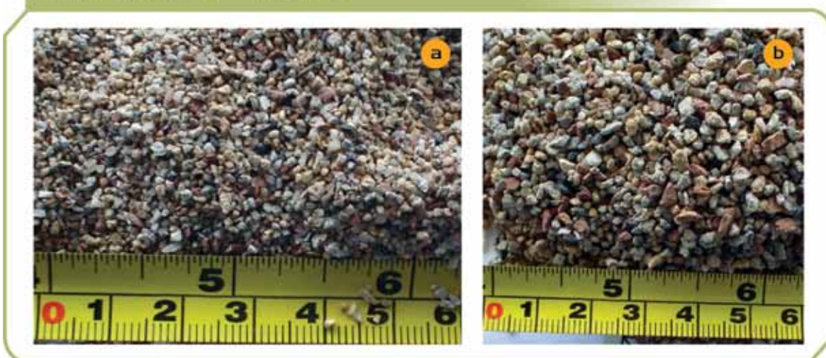
Figura 1 - Diferentes granulometrias de agregados reciclados: (a) miúdo e (b) graúdo
