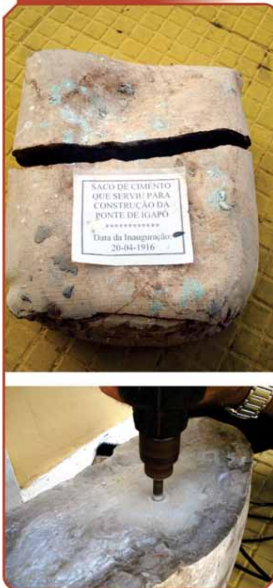
Figura 3 e 4 - Saco de cimento petrificado da época da construção e a extração de seu pó para análise
