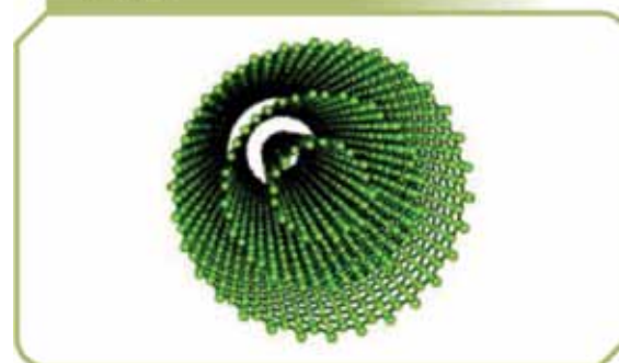
Figura 8 - Nanotubo de carbono de paredes múltiplas (MELO, 2009 apud CAPAZ e CHACHAM, 2003)
