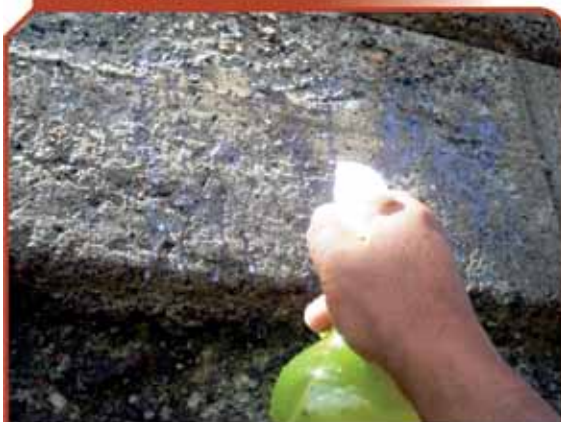
Figuras 7 e 8 – Aspersão de Nitrato de Prata na superfície do bloco e a profundidade de penetração de cloretos
