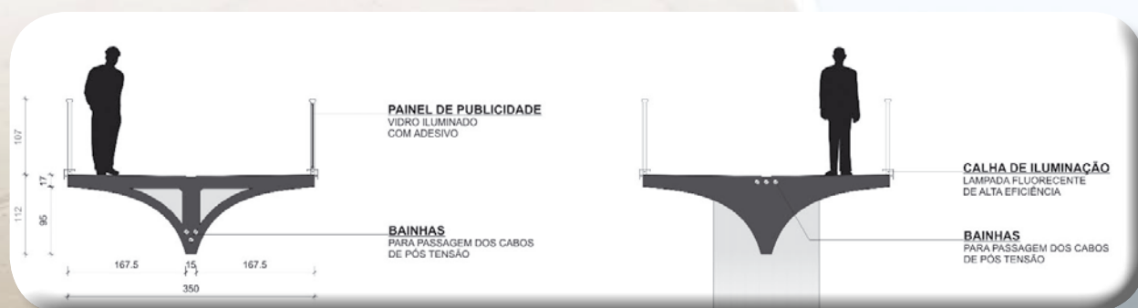
Figura 4: Seções transversais, no vão e apoio
