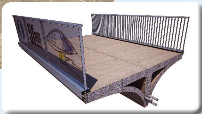
Figura 5: Perspectiva da seção transversal
