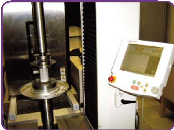
Figura 6 – Ensaio de resistência à compressão em corpo-de-prova
