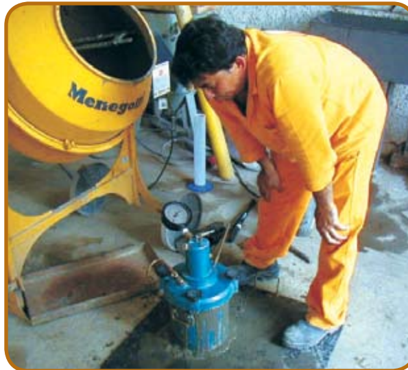
Foto 4 – medição de ar incorporado no concreto
