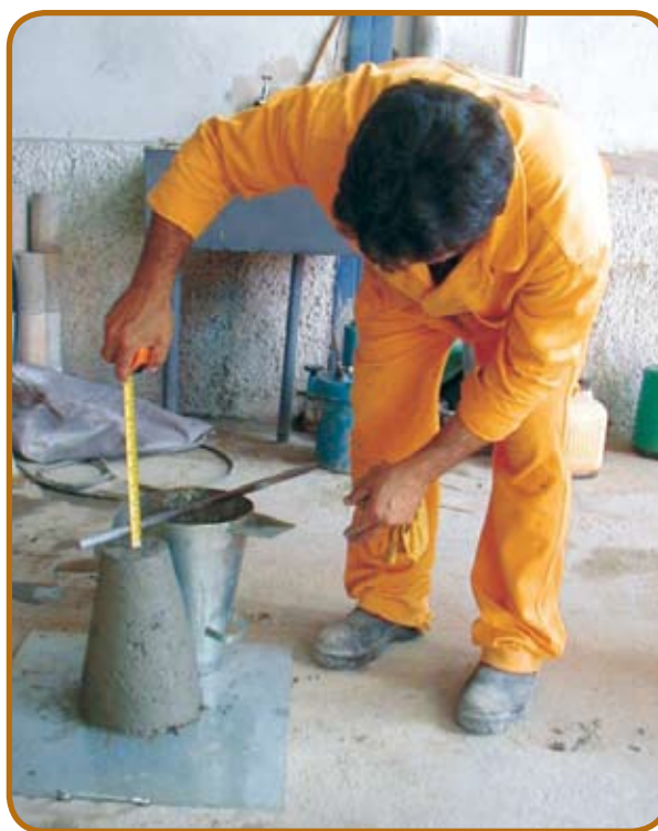
Foto 1 – medição de slump test antes da aplicação do super plastificante
