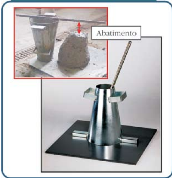
Figura 3 – Abatimento no tronco de cone do concreto
