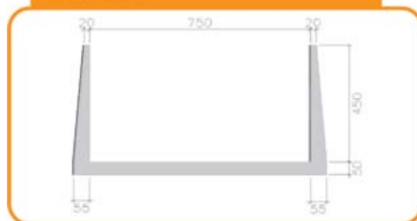
Figura 3.8 – Geometria da seção do canal de adução da Central Hidrelétrica de Alto Fêmeas, BA, 1989
