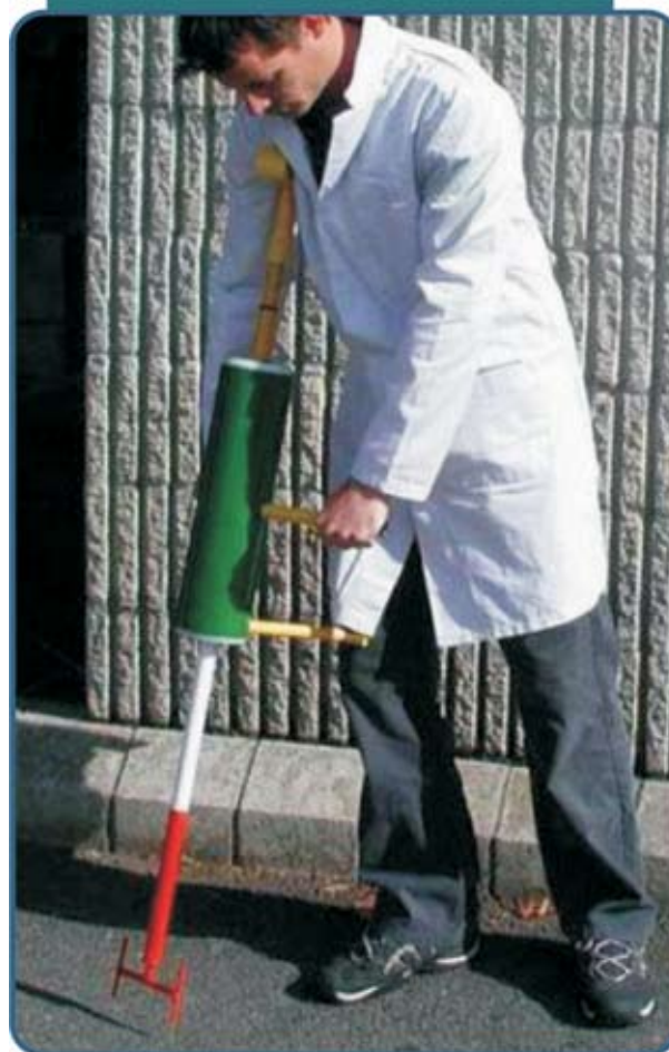
Figura 20 – Reômetro portátil adequado ergonomicamente e que impõe maior rigidez ao equipamento, diminuindo ruídos nas leituras [2]
