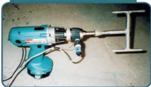
Figura 19 – Reômetro portátil que opera a 5 velocidades, desenvolvido em 2002 [2]
