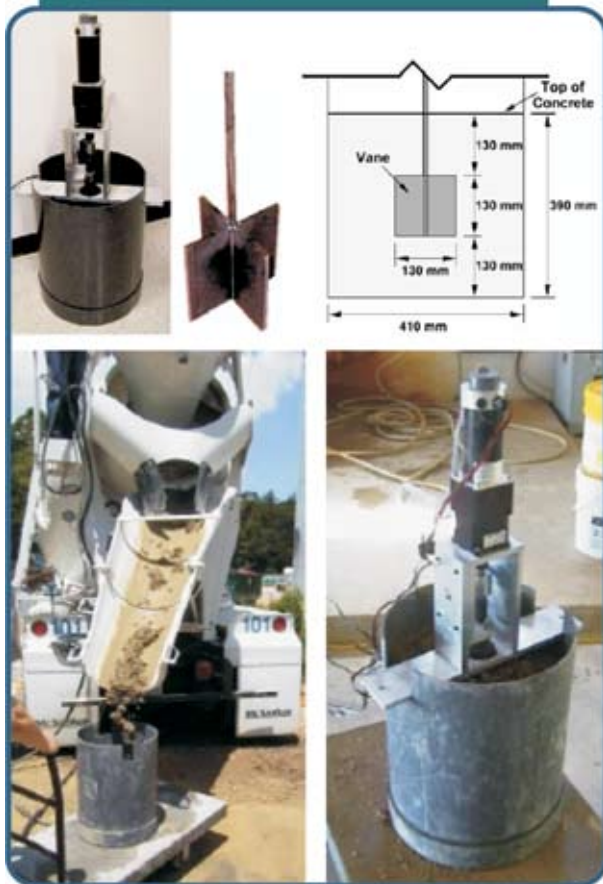
Figura 21 – Reômetro portátil ICAR utilizado para correlacionar os resultados com o caminhão betoneira [11]
