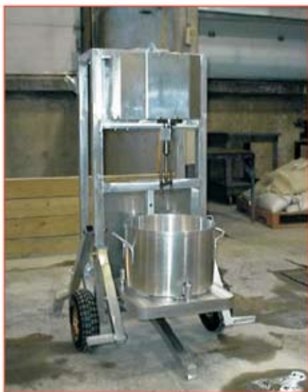
Figura 17 – Reômetro IBB portátil
