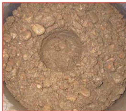
Figura 16 – Exemplo de cisalhamento total de concreto com alta tensão de escoamento, inviabilizando o ensaio por reômetro de cilindros concêntricos
