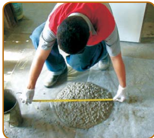
Foto 3 – medição de espalhamento do concreto – flow
