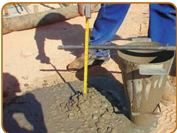
Figura 5 – Estudos do traço de concreto com adição de superplastificante
