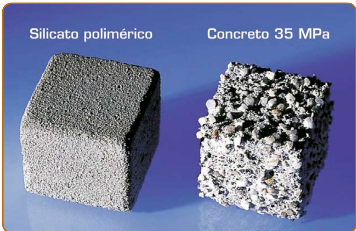
Figura 6 – Teste de contato com ácido em pH menor que 1,0
