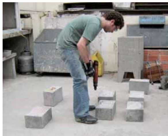
Figura 3 – Realização do ensaio de penetração de pinos
