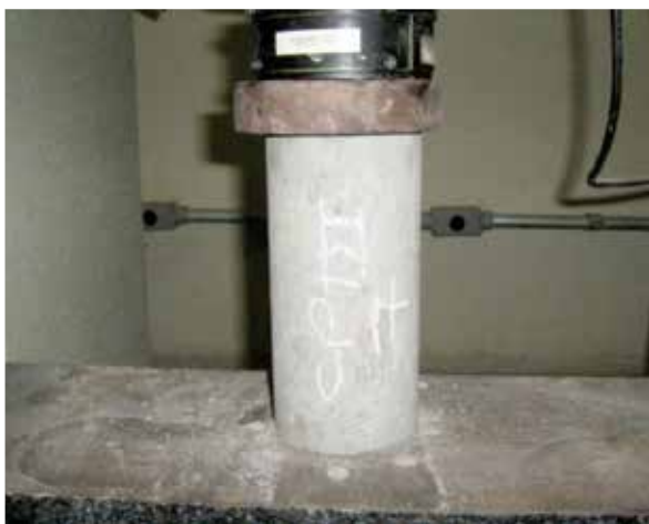
Figura 1 – Corpo de prova na prensa
