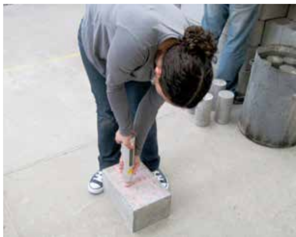
Figura 2 – Realização do ensaio de dureza superficial pelo esclerômetro de reflexão
