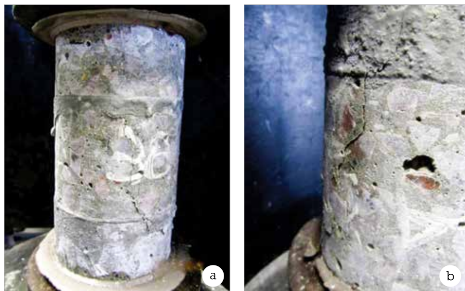
Figura 8 –(a) testemunho tipo T2F após colagem; (b) testemunho T2F após a ruptura cisalhada da maioria dos corpos de prova montados
