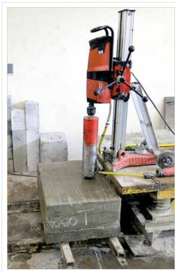
Figura 1 – Equipamento extrator de testemunhos empregado na pesquisa
