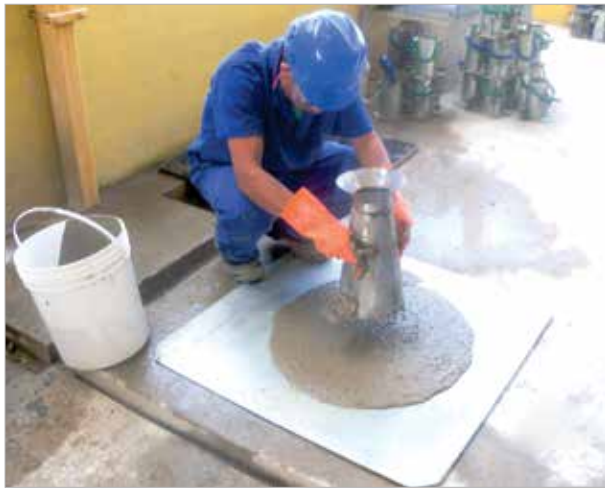
Figura 3 – Ensaio de espalhamento (slump-flow)
