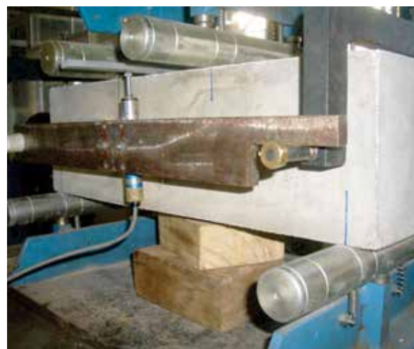
Figura 4 – Determinação da tenacidade no ensaio de tração na flexão
