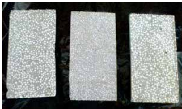
Figura 8 – Seções transversais de corpos de prova de concreto leve
