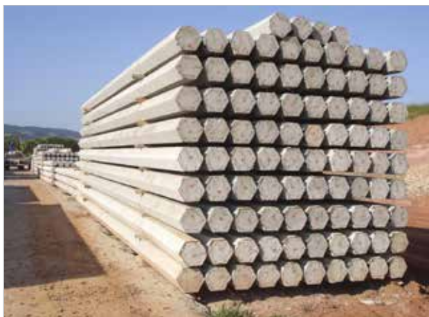
Armazenamento de estacas pré-fabricadas na indústria
