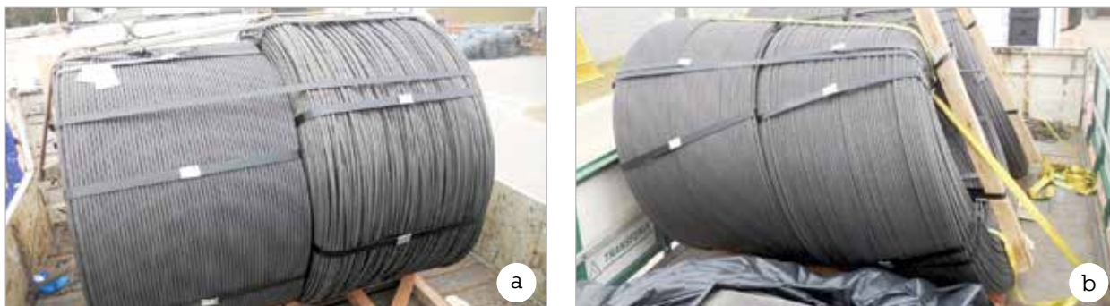
Figura 1 – Não conformidade no recebimento de rolos de cordoalhas. (A) Rolo tombado (B) Detalhe do desalinhamento do rolo de cordoalha
