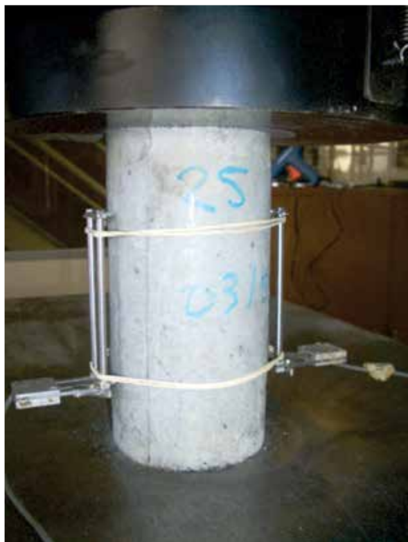
Figura 1 – Determinação do módulo de elasticidade em corpo de prova cilíndrico
