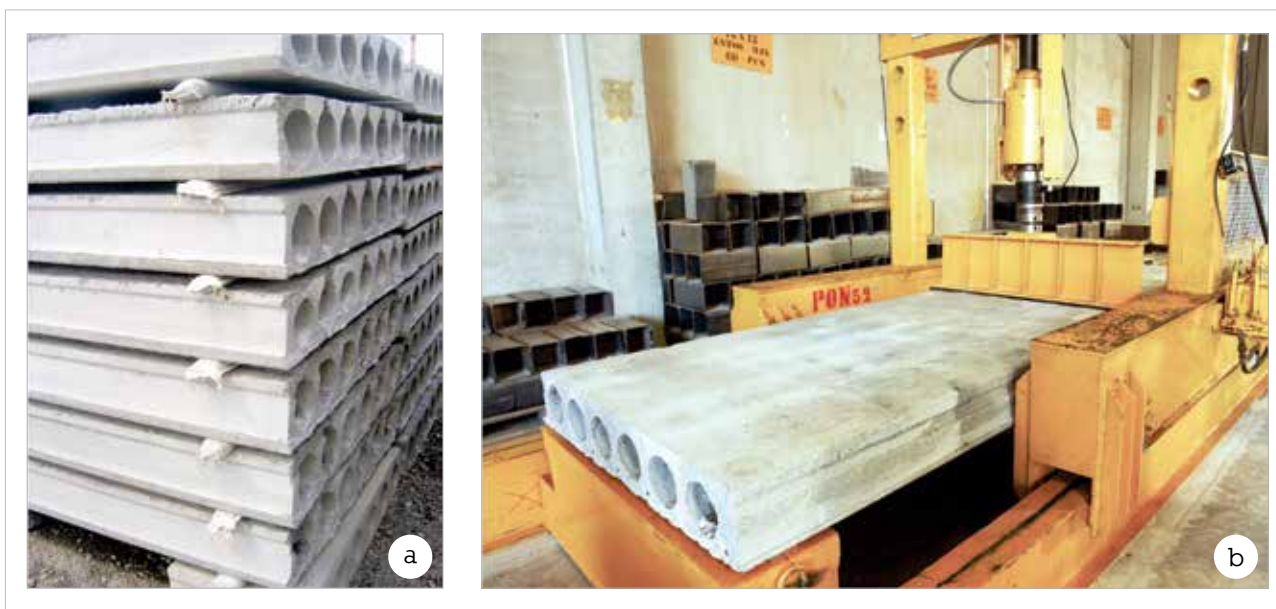
Figura 1 – Exemplo de lajes alveolares com alvéolos circulares, sendo (a) armazenamento e (b) comprovação experimental em fábrica
