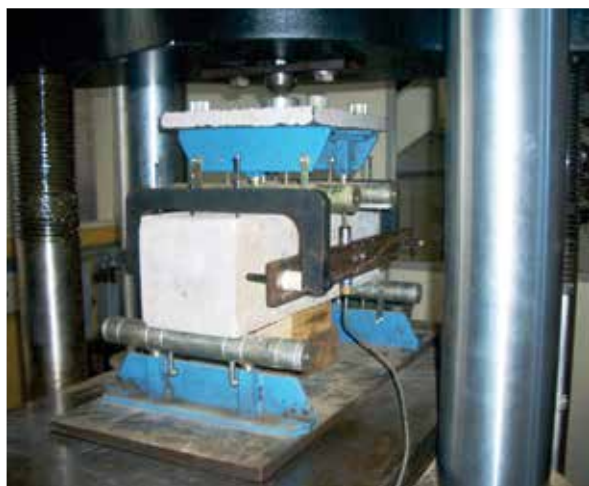
Figura 3 – Ensaio de tração na flexão de corpo de prova prismático
