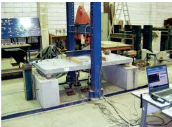
Figura 9 – Ensaio de laje unidirecional de concreto leve
