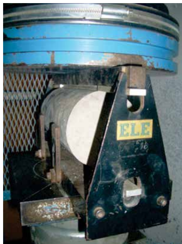
Figura 2 – Ensaio de tração na compressão diametral de corpo de prova cilíndrico
