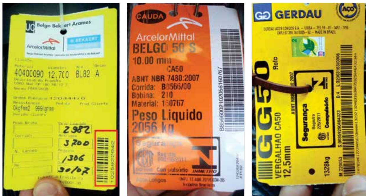
Figura 2 – Etiquetas de identificação em rolos de aço - detalhe do número da corrida para rastreabilidade do produto
