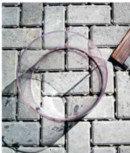
Figura 7 – Cilindro acrílico posicionado no pavimento permeável para realização do ensaio para determinação do coeficiente de permeabilidade
