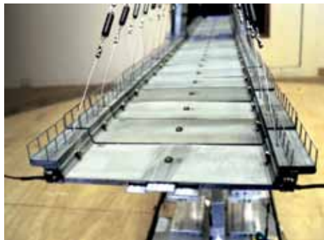
Figura 5 - Detalhes construtivos de um módulo do modelo reduzido do tabuleiro
