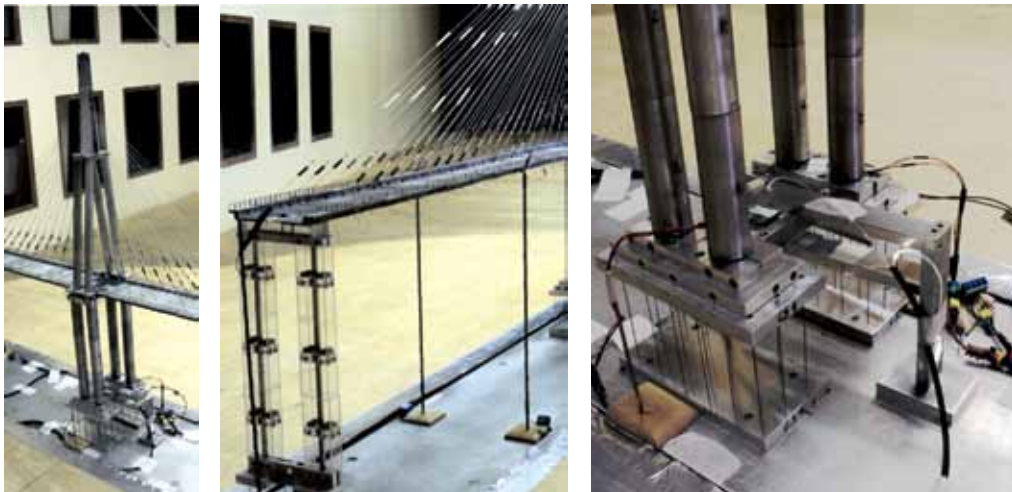
Figura 7 - Modelo aeroelástico da Ponte Estaiada sobre o Rio Negro no interior do Túnel de Vento. Esquerda: vista geral do mastro. Centro: esqueleto de alumínio projetado para representar a rigidez e parte da massa do mastro e apoios de extremidade. Direita: detalhes da base do modelo
