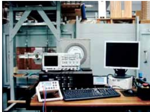
Figura 2 - Modelo seccional do tabuleiro, em apoios flexíveis, para medição da resposta dinâmica. Esquerda: vista do aparato experimental para medição da resposta dinâmica. Direita: detalhe do sistema de apoio do modelo seccional
