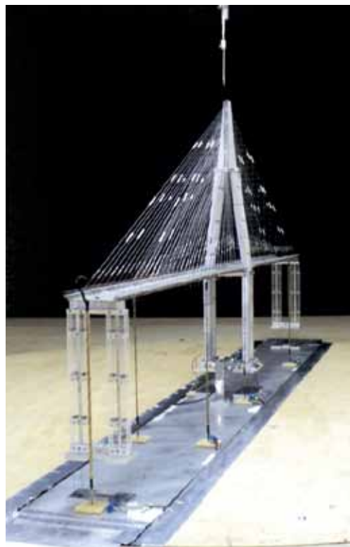
Figura 6 - Modelo aeroelástico da Ponte Estaiada sobre o Rio Negro no interior do Túnel de Vento. Esquerda: configuração incompleta. Direita: configuração completa
