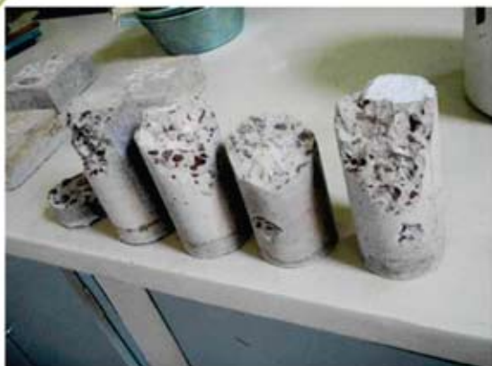
Figura 1 – Lascamentos explosivos, com perda de material, de concreto de resistência à compressão de 75MPa, observados no LEMC-UNICAMP
