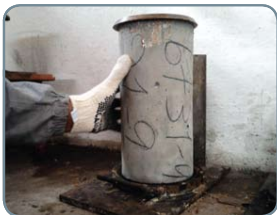
Detalhe da aplicação do enxofre nas faces do corpo de prova
