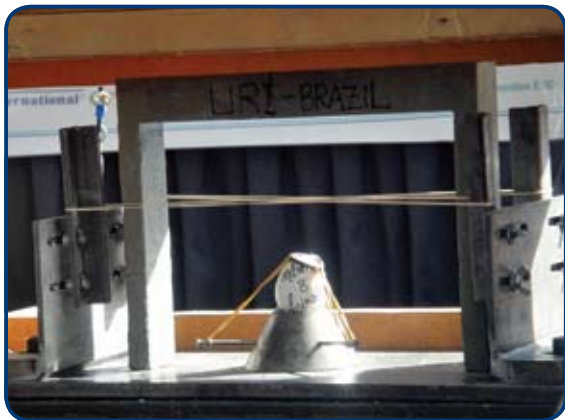
EPD URI pronta para ensaio de rompimento
