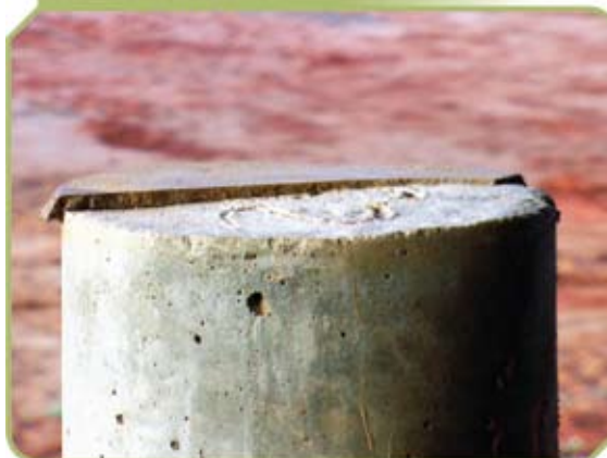
Foto 4 – Diferença na espessura no capeamento com enxofre
