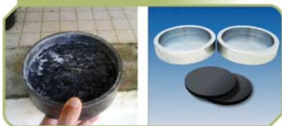
Foto 9 – Capeador elastomérico confinado
