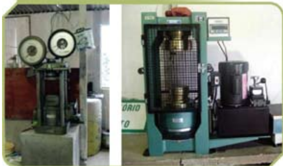
Foto 11 – Laboratório de obra - Prensa antiga sem controle de velocidade e prensa moderna com controle de velocidade de carga
