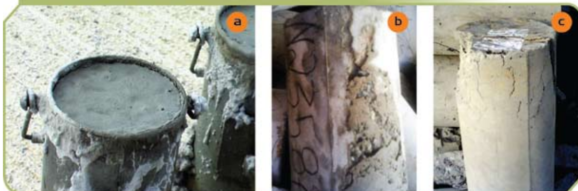
Foto 3 – Concreto com excesso de exsudação
