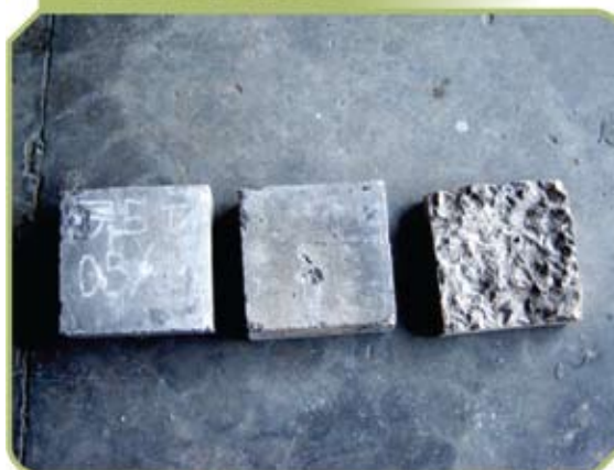
Figura 10 – Lascamentos explosivos, com perda de material, de concreto de resistência à compressão de 75MPa, observado no LEMC-UNICAMP, em ensaio de avaliação da tendência ao lascamento explosivo proposto
