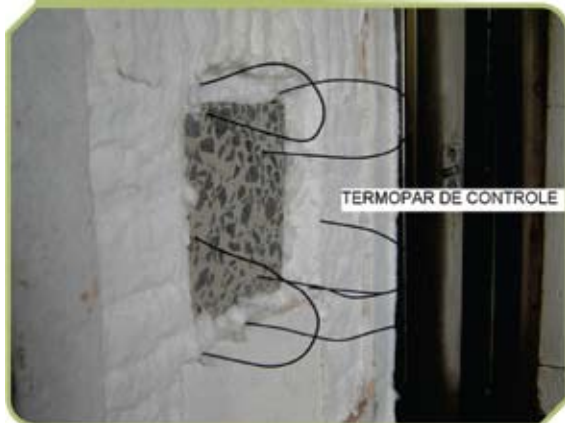
Figura 8 – Posicionamento dos instrumentos para medida de temperatura (TERMOPARES) na face da amostra de concreto e a 10 cm desta face (TERMOPAR DE CONTROLE)
