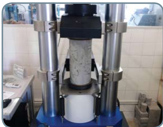
Amostra preparada para ruptura na prensa hidráulica
