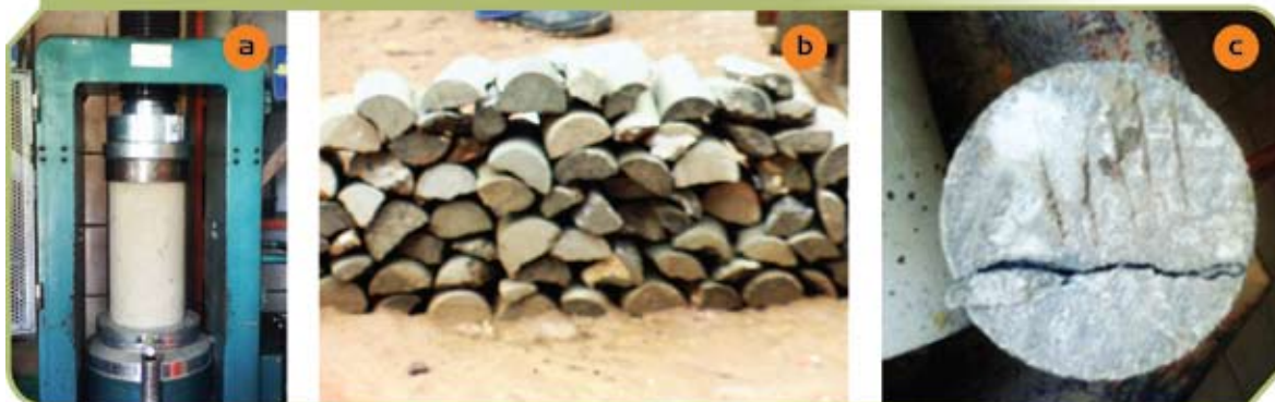
Foto 10 – Consequências da ruptura com capeamento elastomérico
