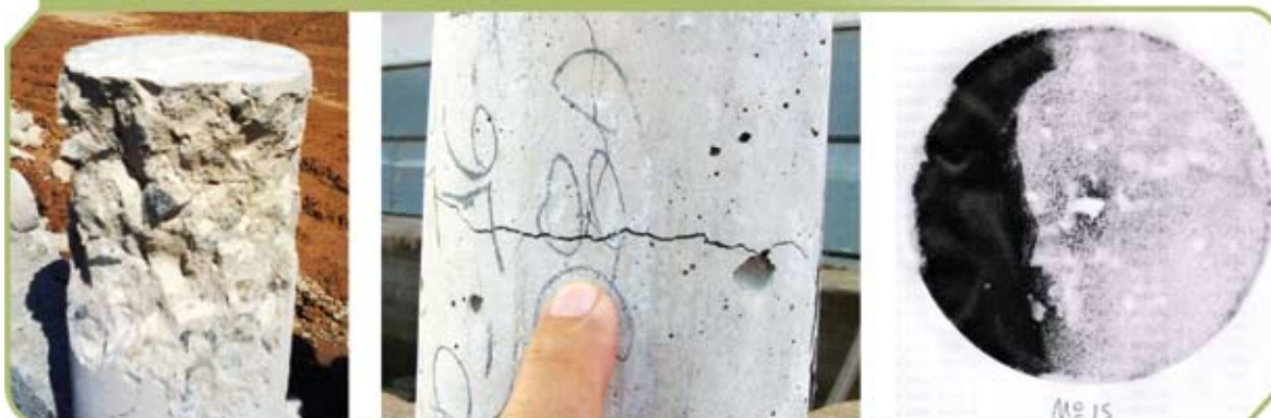
Foto 8 - Falha no paralelismo: ruptura por compressão, de um lado, e, tração, do outro
