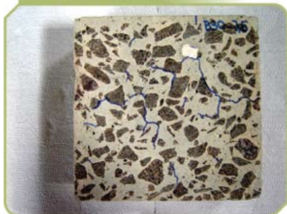
Figura 9 – Detalhe de amostra de concreto de resistência à compressão de 25MPa, após ensaio de avaliação da tendência ao lascamento explosivo proposto. Notar marcação das fissuras.
