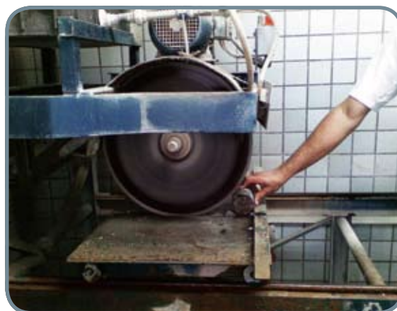
Vista do equipamento de serra mármore utilizado para o desgaste dos tops
