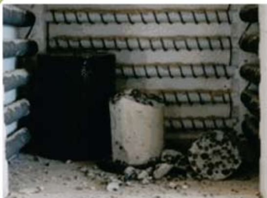
Figura 3 – Lascamento explosivo, observado no LEMC-UNICAMP para concreto leve (argila expandida como agregado graúdo)
