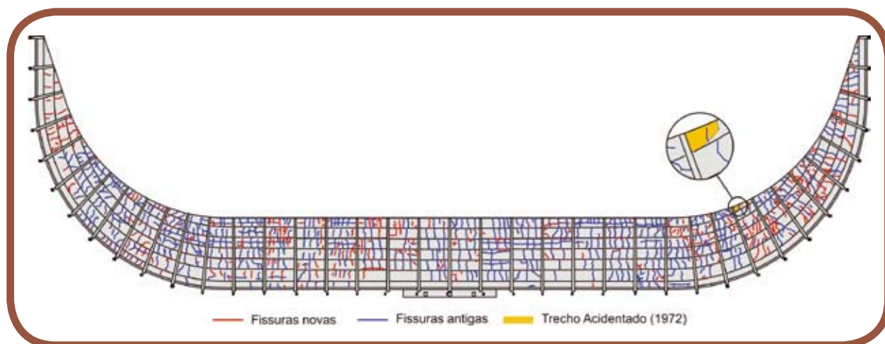
Figura 6: Mapeamento das Fissuras da Marquise. Lima ET AL [3]
