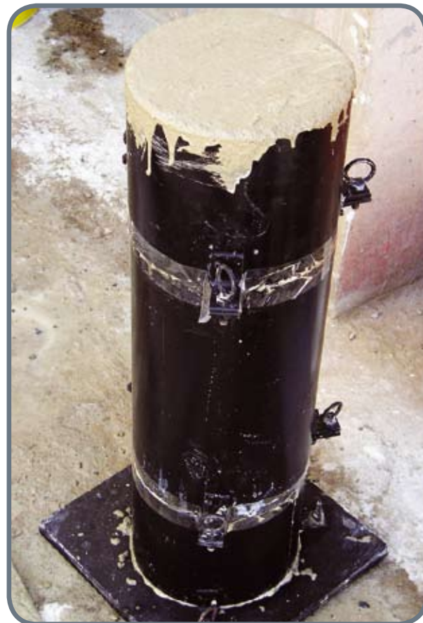
Preparo de corpo-de-prova – para controle de aceitação
