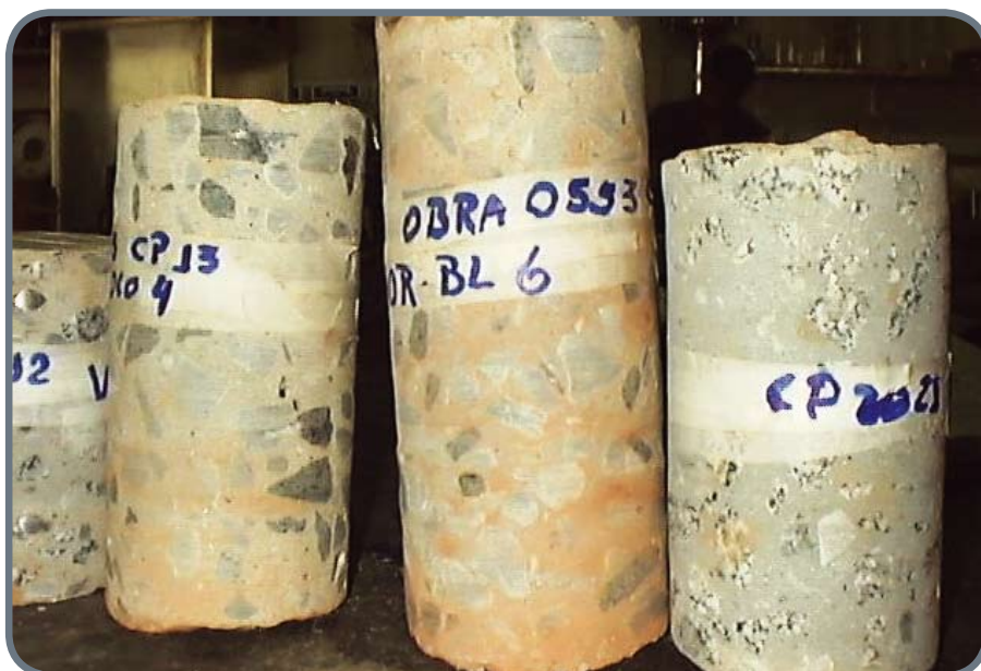
Corpos-de-provas preparados para serem ensaiados
