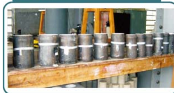
Figura 4 – Pilares Mistos já ensaiados para estudo do efeito do confinamento
