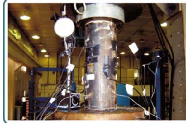
Figura 3 – Instrumentação externa dos pilares mistos
