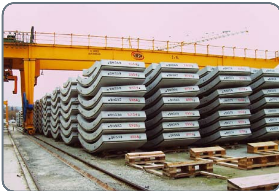
Peças pré-fabricadas de concreto – a plasticidade é fator essencial para assegurar forma e dimensão
