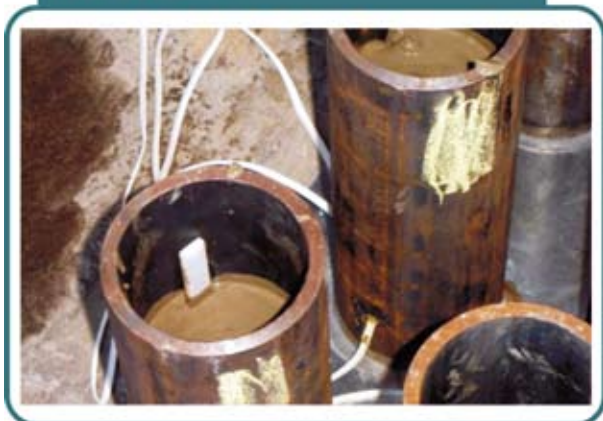
Figura 1 – Concretagem dos tubos e posicionamento dos Strain gages no concreto
