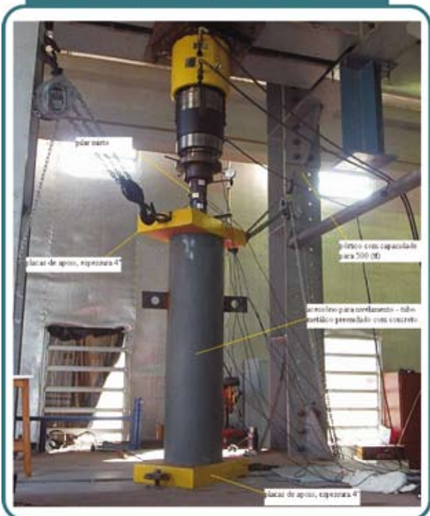
Figura 2 – Sistema de aplicação de força para os pilares mistos
