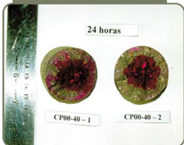
Figura 3 – Corpos-de-prova cilíndricos parcialmente carbonatados
