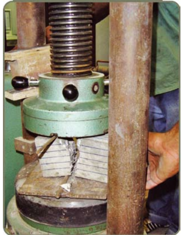
Figura 9 – Ruptura do corpo-de-prova para retirada da fatia a ser ensaiada
