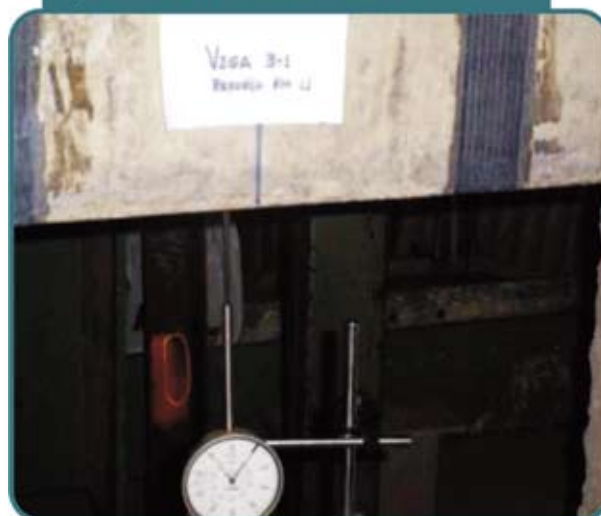
Figura 4 – Relógio comparador para determinação das flechas
