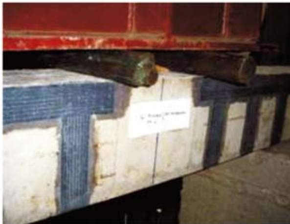
Figura 8 – Detalhe do ensaio para a viga V4
