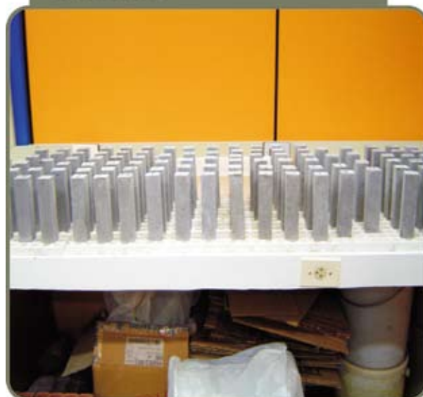
Figura 5 – Amostras em pré-condicionamento em ambiente com umidade e temperatura controladas
