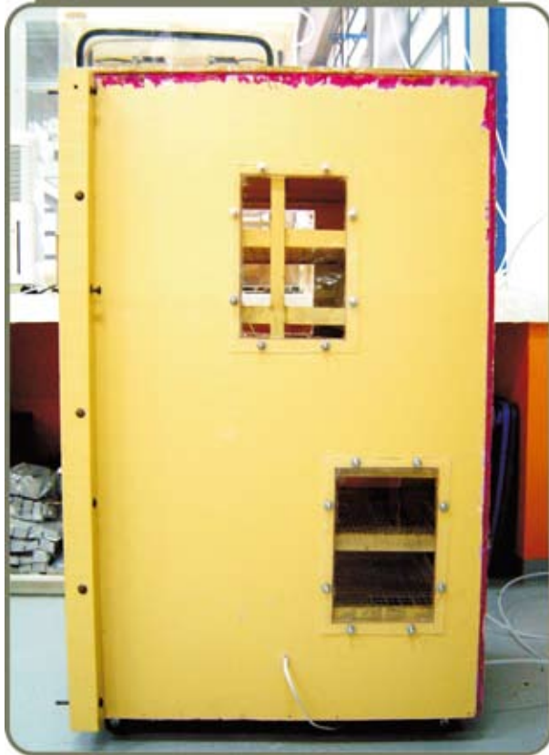
Figura 8 – Câmara de carbonatação em compensado, com “janelas” em acrílico
