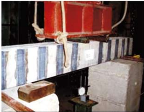
Figura 7 – Detalhes dos ensaios para as vigas V3-1 e V3-2
