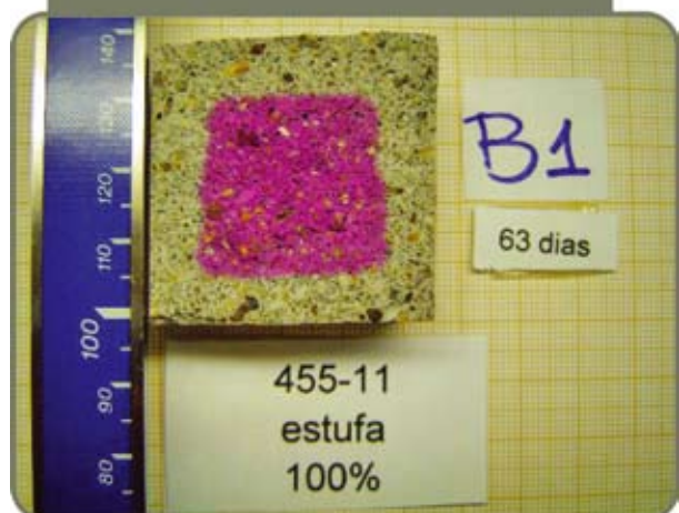
Figura 11 – Imagem digital para medida da frente de carbonatação
