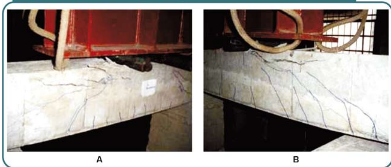
Figura 5 – Detalhe do ensaio para a viga V1
