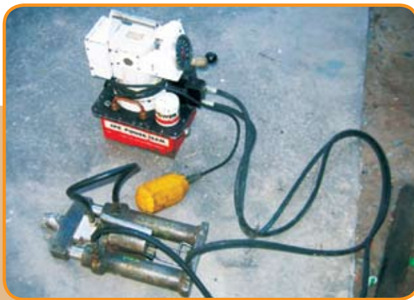
Bomba e macaco hidráulicos para fixar ancoragens mortas nos cabos.
