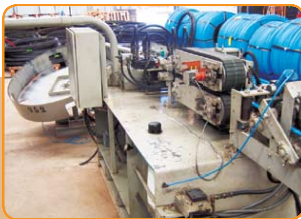
Sofisticada máquina de corte de cordoalhas, formando os cabos e enrolando-os ao final.
