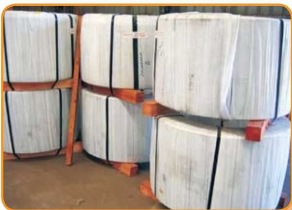
Bobinas de cordoalhas nuas entregues com eixo vertical, adequado para os equipamentos automatizados em central de corte e dobra de vergalhões.
