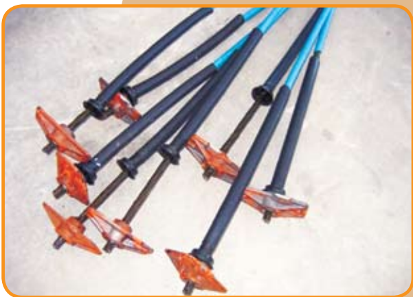
Ancoragens mortas presas em ponta de cabo.
