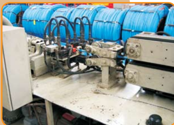
Caterpillar de tração das cordoalhas e a parte de corte da capa plástica e da cordoalha.
