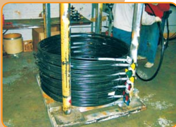
Dispositivo receptor de cordoalhas cortadas e enroladas prontas para pintura identificadora
