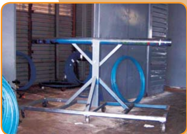
Cabide receptor de cordoalhas cortadas e enroladas prontas para pintura identificadora
