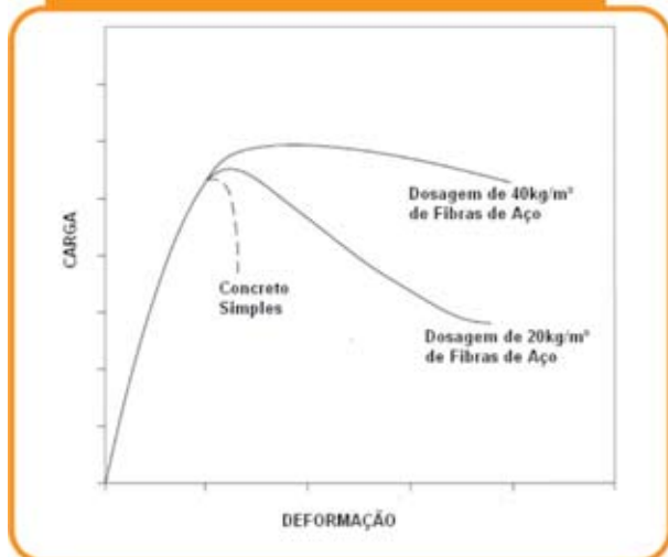
Figura 5 – Exemplo de curvas típicas tensão-deformação para concretos simples e reforçados com diferentes dosagens de fibras de aço
