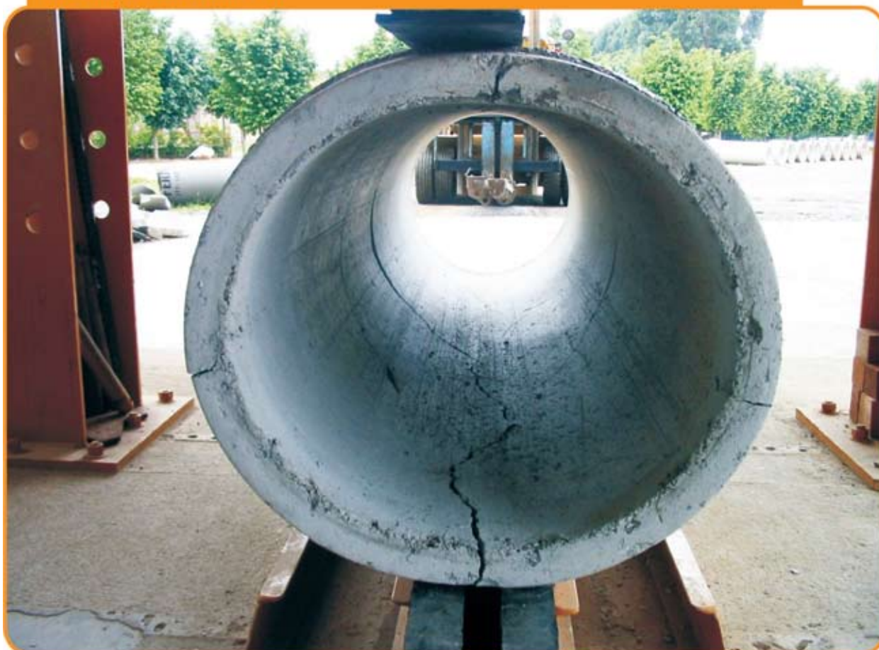
Figura 2 – Tubo de concreto com fibras sendo submetido ao ensaio de compressão diametral
