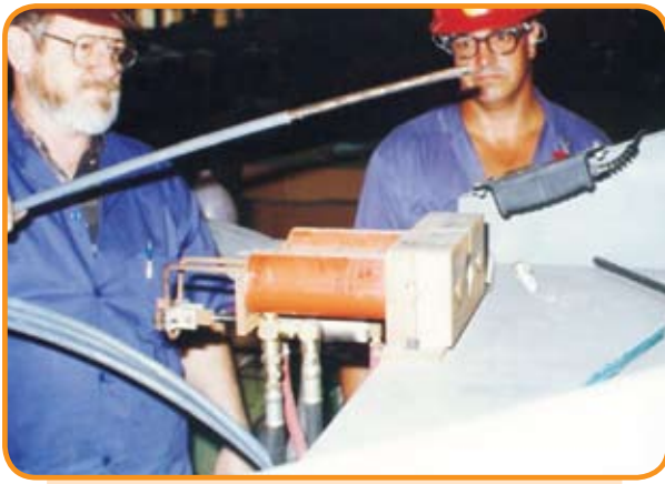
Bancada de fixação de ancoragem morta na ponta dos cabos.
