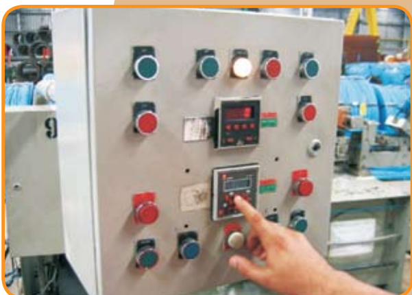
Controle numérico da produção onde se registram o número de cabos de mesmo comprimento.
