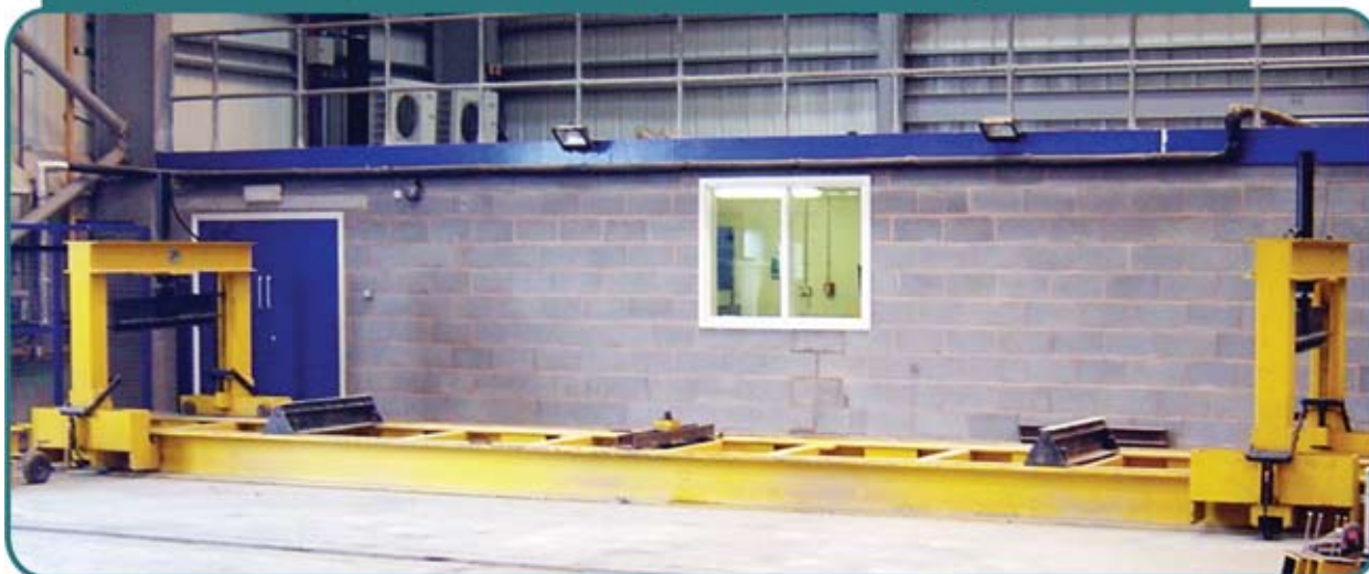
Figura 2 – Sistema de estrutura de reação para de ensaios de controle de qualidade em lajes alveolares (BISON Precast Concrete, Inglaterra, 2007)
