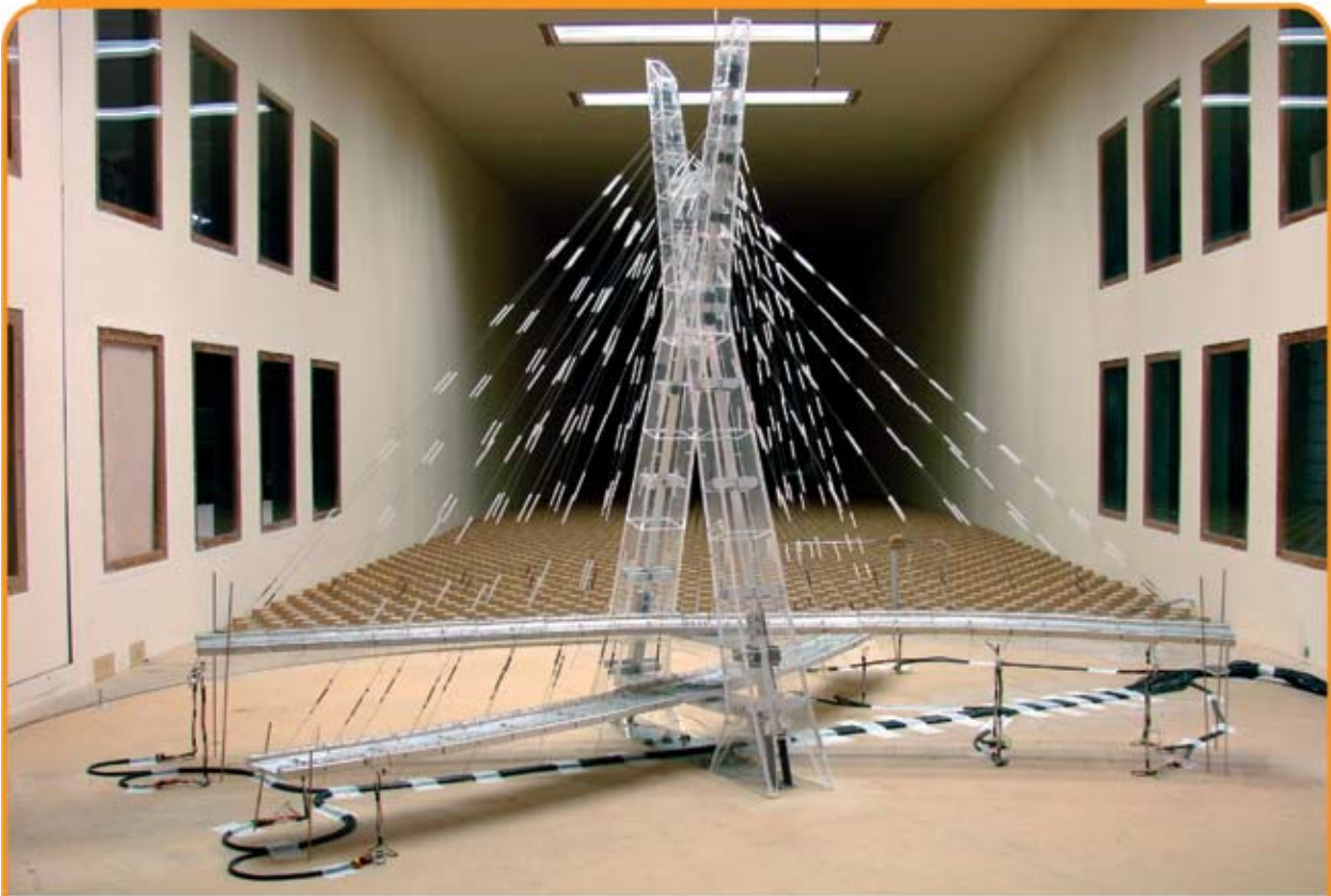
Figura 4 – Modelo aeroelástico de etapa construtiva do Complexo Viário Jornalista Roberto Marinho no interior do Túnel de Vento e típica resposta do tabuleiro. Construtora: OAS
