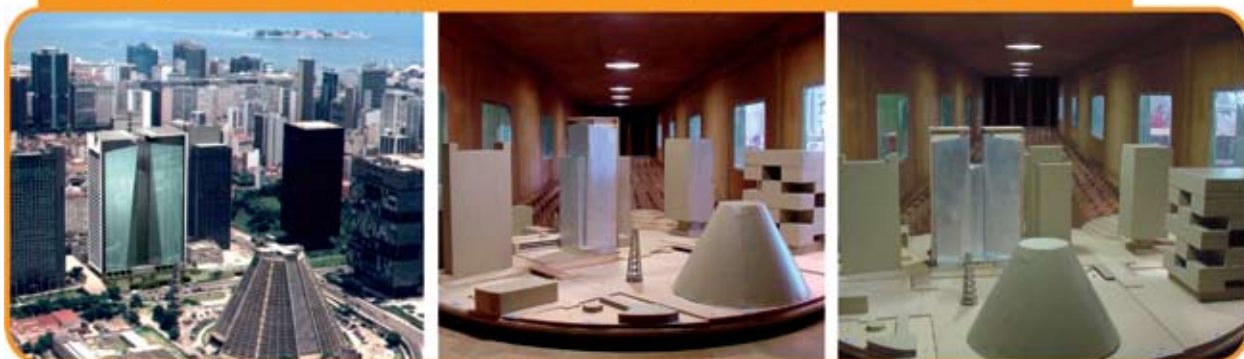
Figura 9 – Perspectiva artística e modelo reduzido em túnel de vento das fases construtivas do Empreendimento Tishman Speyer / Camargo Corrêa - Ventura, Rio de Janeiro. Projeto estrutural: JKMF, São Paulo
