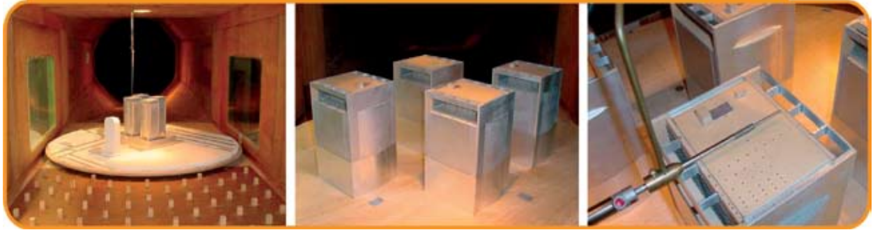
Figura 12 – Modelo reduzido em túnel de vento do Empreendimento Matec / Takaoka - SP Wellness, Alphaville, Barueri, SP, para determinação das características do escoamento em helipontos. Projeto estrutural: Eng. Francisco Graziano, São Paulo
