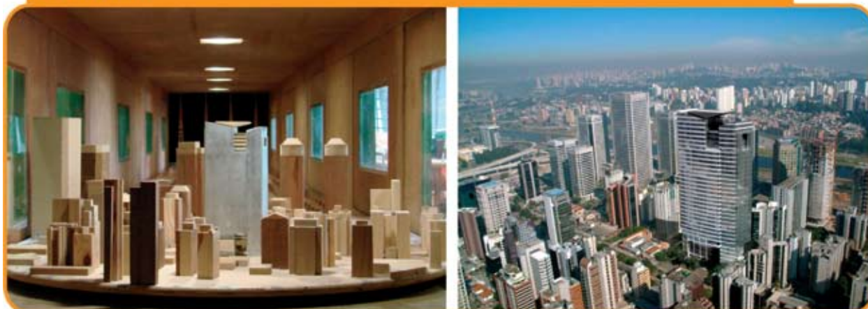
Figura 3 – Modelo reduzido no túnel de vento do Empreendimento Prosperitas e sua inserção urbana na cidade de São Paulo, SP. Projeto estrutural: JKMF, São Paulo
