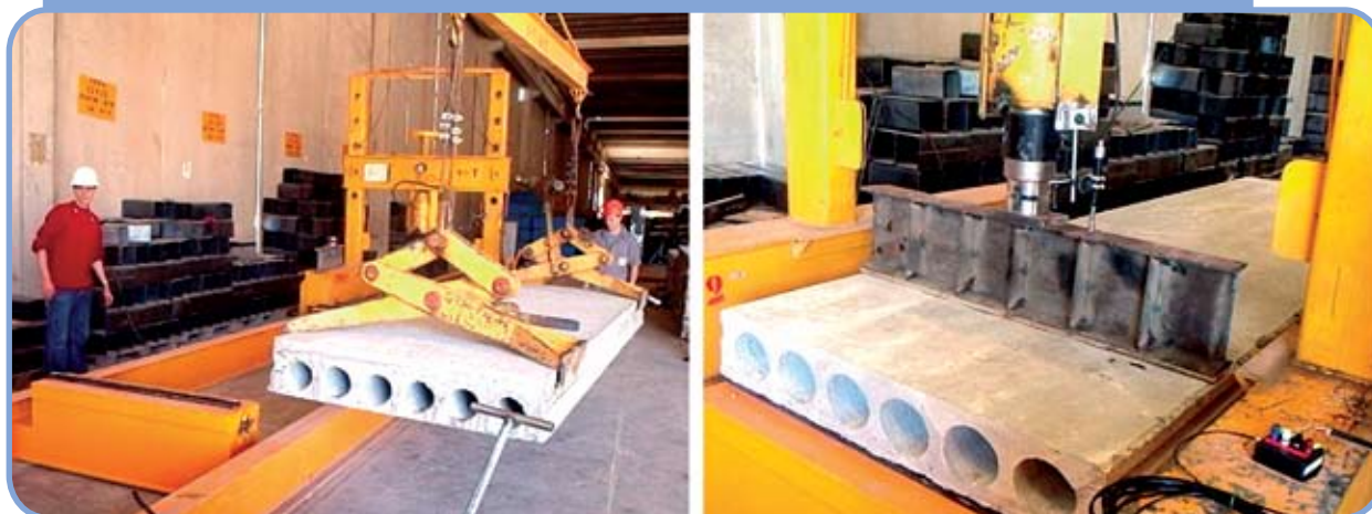
Figura 2 – Ensaio de Cisalhamento em Lajes Alveolares na CASSOL – Fábrica de Araucária - PR
