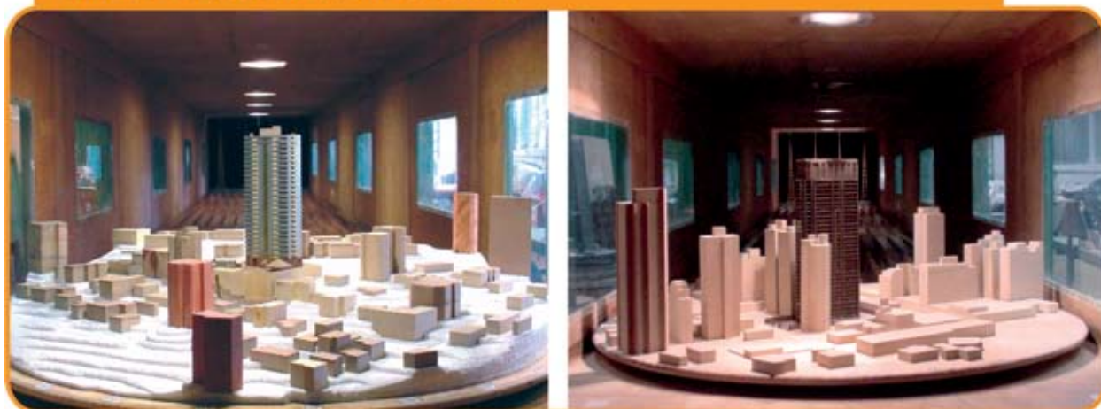
Figura 5 – Modelagem da camada limite e do local específico para prédios construídos em Novo Hamburgo, RS (Mosmann - Sunset Residence - Projeto: Adamy Projetos Especiais) e São Paulo, SP (INPAR - L' Essence Jardins - Projeto: Franca e Associados)
