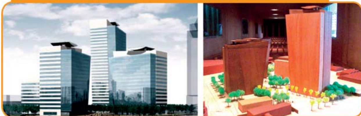
Figura 10 - Perspectiva artística e modelo reduzido em túnel de vento para conforto de pedestres do Empreendimento Tishman Speyer / Método - Rochaverá, São Paulo. Projeto estrutural: JKMF, São Paulo
